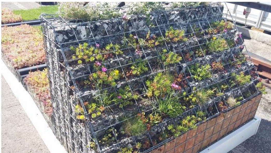
Obrázek 22: Prototyp gabionové clony s přirozenou vegetací. [19]
