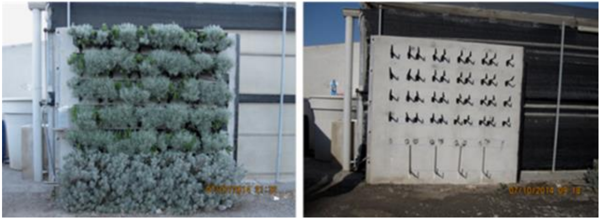
Obrázek 24: Prototyp betonové clony s možností osazení vegetace. [21]
