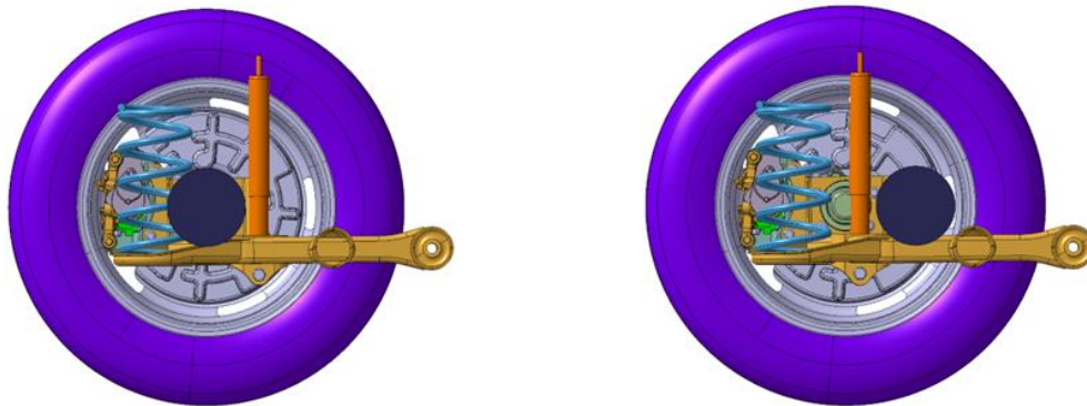
Obrázok 54 Náprava s vlečnými ramenami a torznou tyčou – koncept č.2, umiestnenie elektromotoru vľavo – v osi kola, vpravo – mimo os kola
