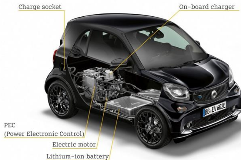
Obrázok 3 Elektrická pohonná jednotka vozu Smart EQ [4]
