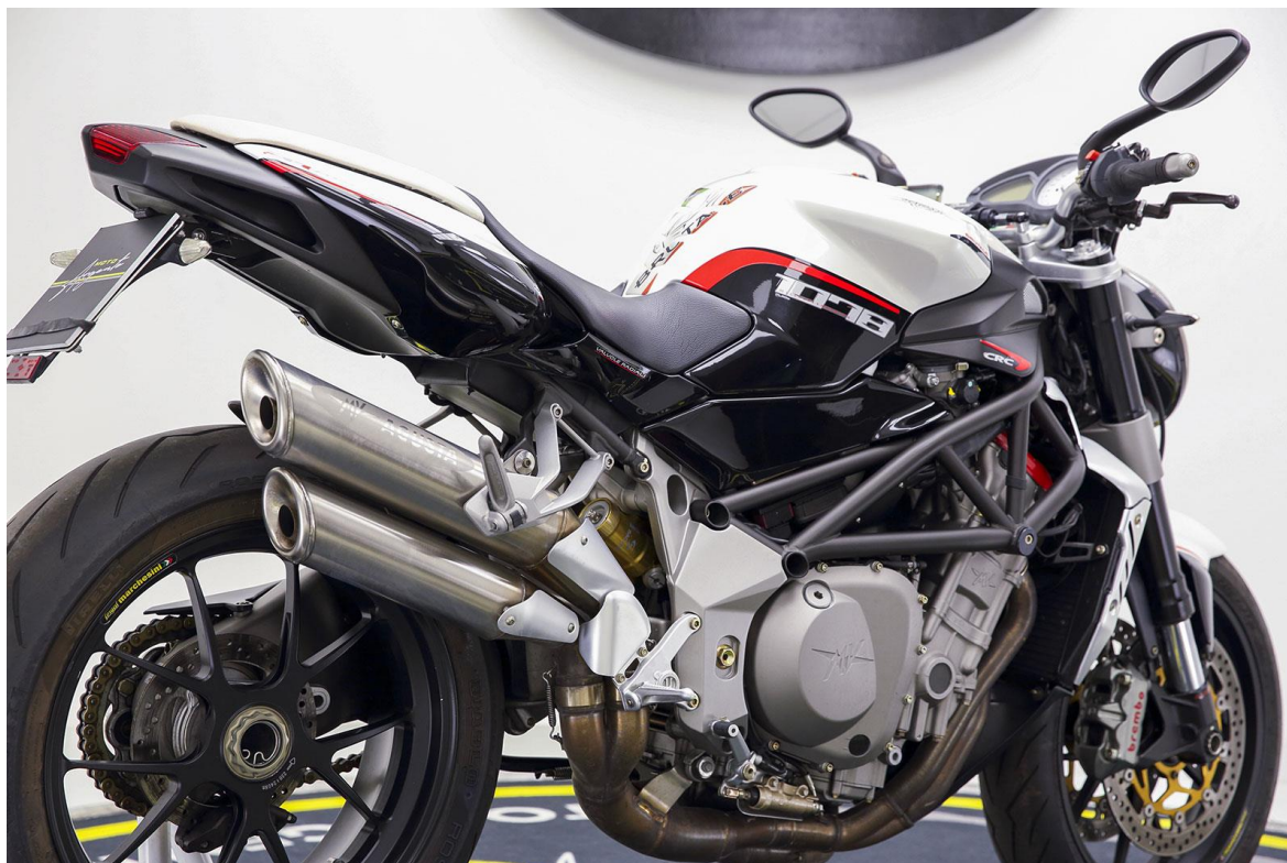
Obrázek 22 - Motocykl MV Agusta Brutale 1078RR s kombinovaným rámem [25]
