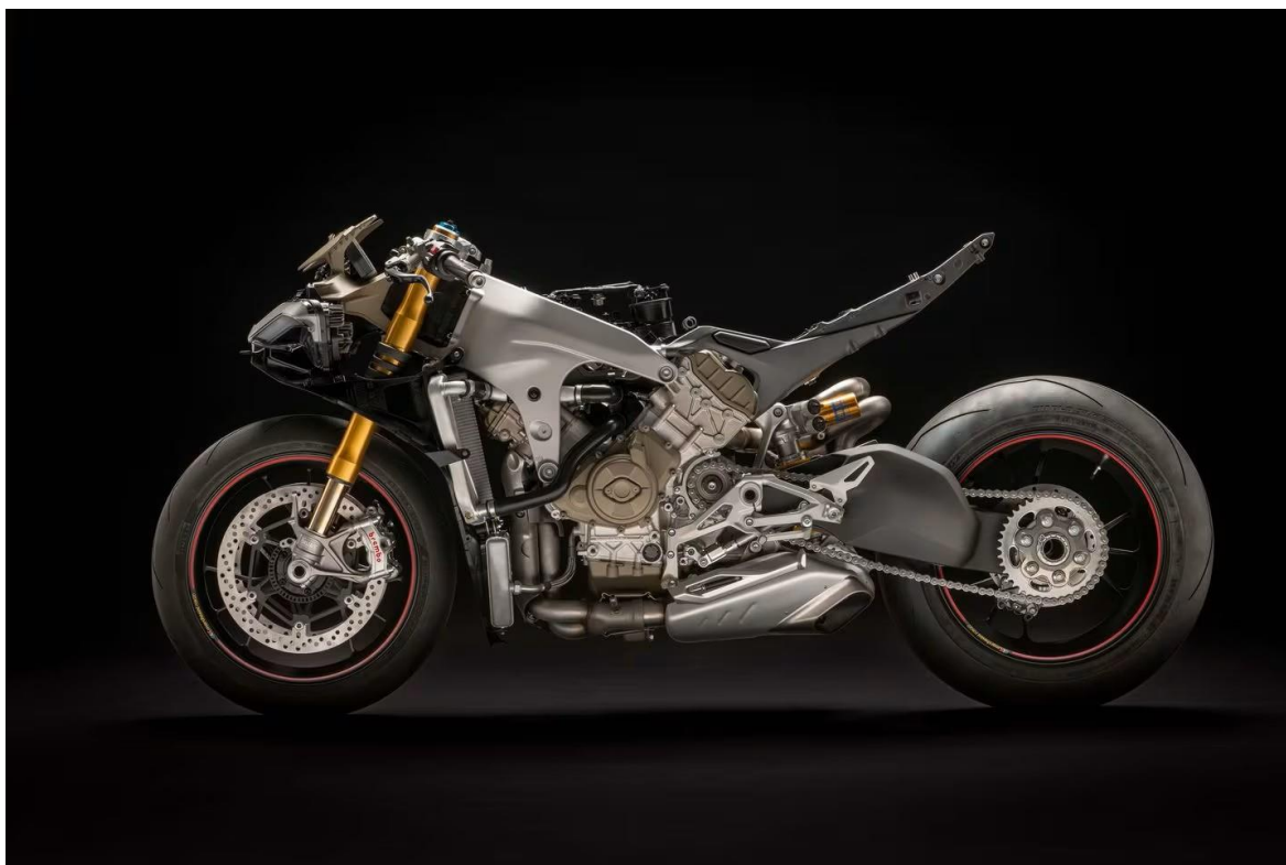
Obrázek 23 - Ducati Panigale V4 s konstrukcí využívající pohonnou jednotku jako hlavní nosný prvek [26]
