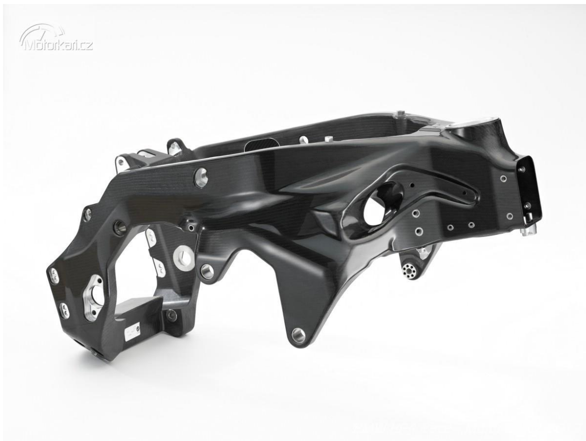
Obrázek 25 - Rám z uhlíkových vláken motocyklu BMW HP4 RACE [32]
