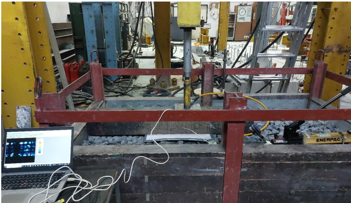
Obr. 29: Průběh měření: sestavený model a zapojení kompletní měřicí soustavy při uložení pražce v poloze 1, pohled zepředu [Zdroj: Autor]
