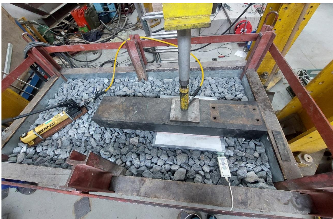
Obr. 30: Průběh měření v poloze 2, pražec plastový na kamenivu ostrohranném, pohled shora [Zdroj: Autor]
