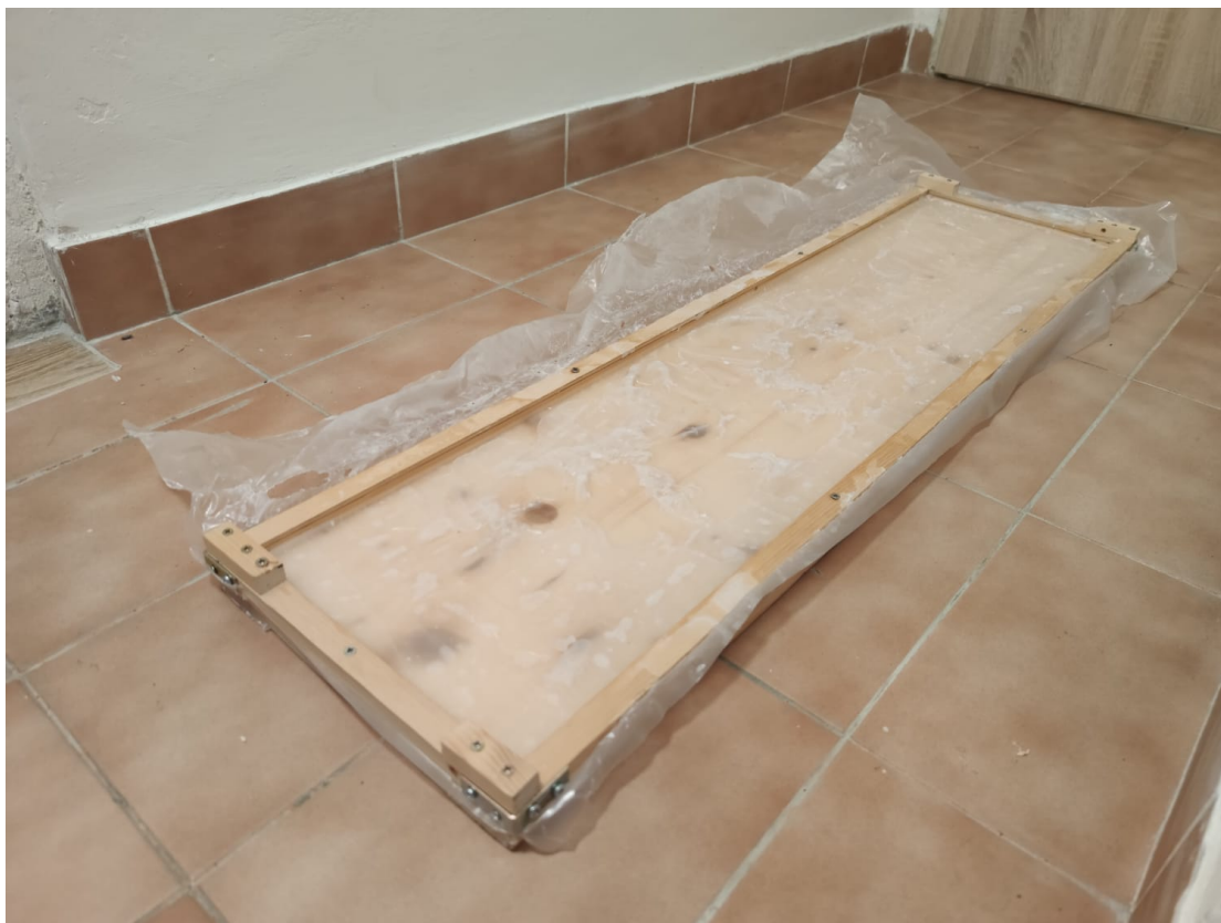
Obrázek 2.2: Zhotovená forma pro odlévání parafinových plátů
