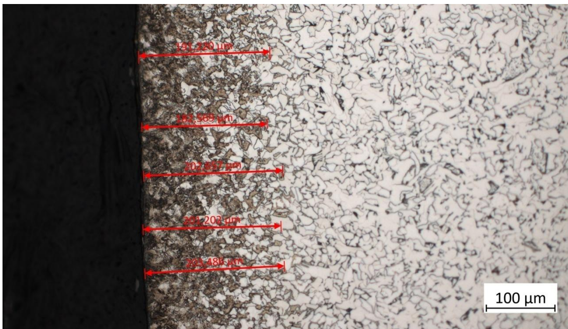
Obrázek 38: Měření tepelně ovlivněné oblasti u vzorku 1A v místě "a"
