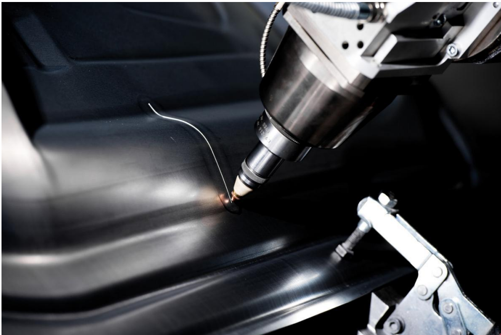
Obrázek 6: Řezání 3D tvaru pomocí laseru [8]
