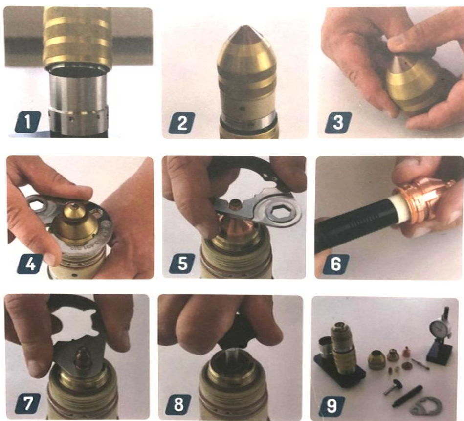
Obrázek 15: Popis jednotlivých kroků při demontáži hořáku
