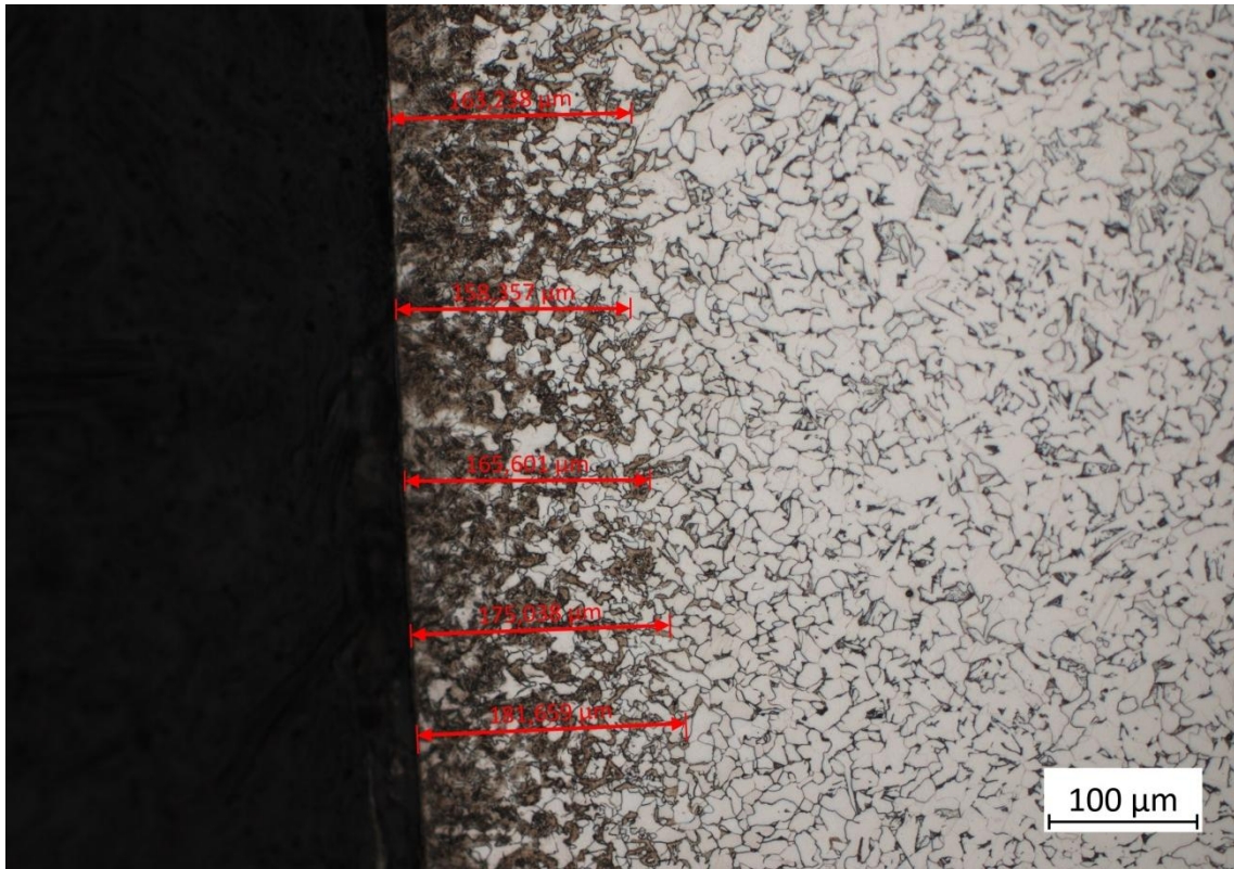
Obrázek 40: Měření tepelně ovlivněné oblasti u vzorku 1A v místě "c"
