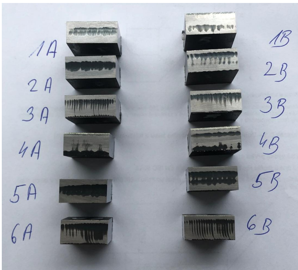
Obrázek 51: Vybrúšené vzorky na zkoušku tvrdosti
