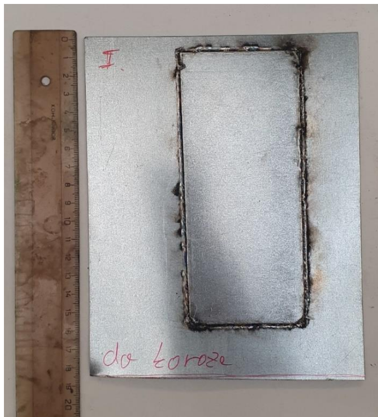
Obr. 41 – Vzorek 1 – před exploatací korozním testem – koutově přeplátovaný svar
