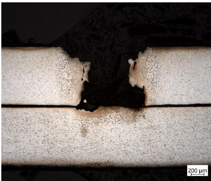
Obr. 32 – DX 51 Z275 0,9 mm – expanze svarové lázně
