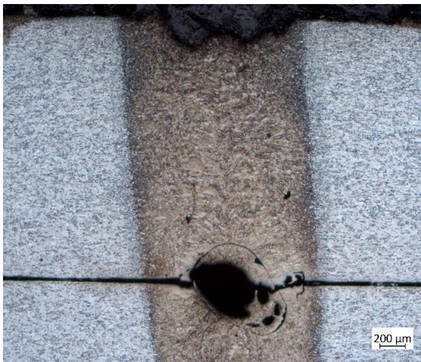
Obr. 34 – S320 GD Z140 2,0 mm – masivní pórovitost
