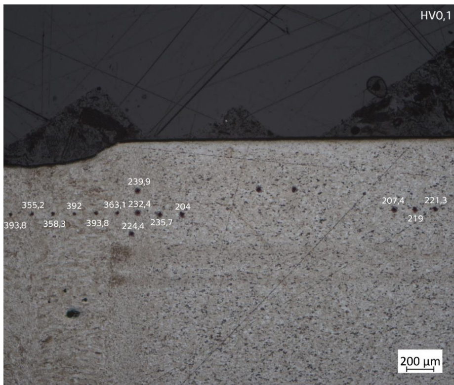
P. 2 – Znáznornění průběhu mikrotvrdosti u materiálu S320GD Z140 2 mm - 2
