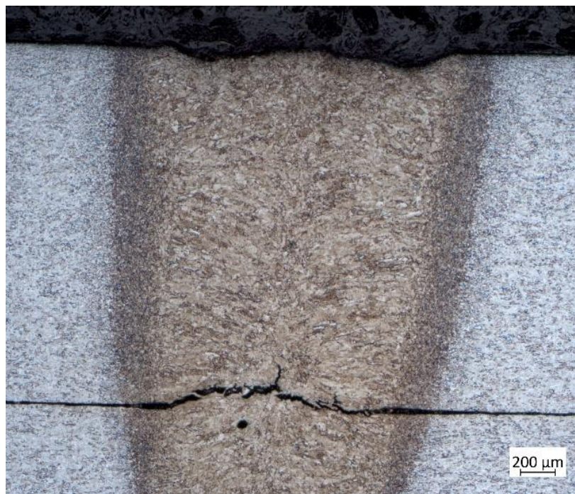
Obr. 33 – S320 GD Z140 2,0 mm – vnitřní trhliny
