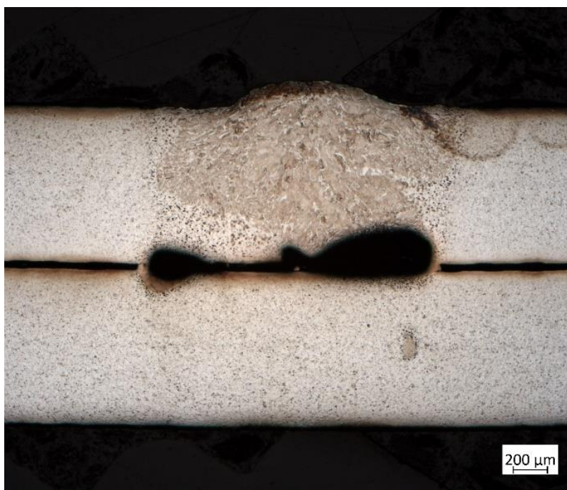
Obr. 31 – DX 51 Z275 0,9 mm – masivní pórovitost
