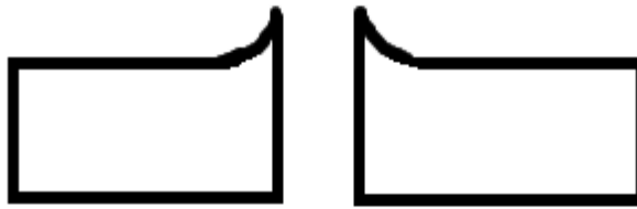
Obr. 21 – Orientace střížných hran plechu směrem nahoru
