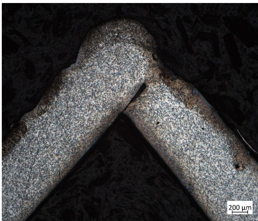
Obr. 38 – DX 51 Z275 0,9 mm – rohový svar s tepelně ovlivněnými zónami
