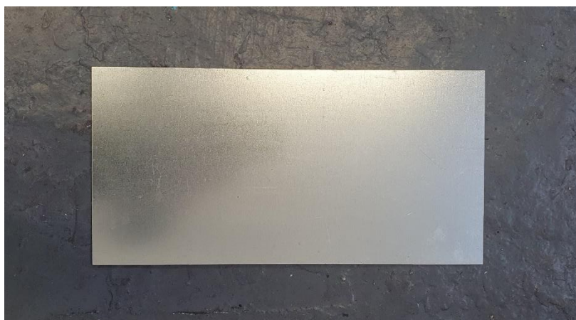
Obr. 20 – Vzorek 300x150 mm – výchozí rozměr plechu
