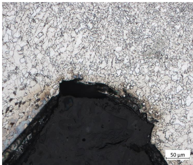
Obr. 40 – DX 51 Z275 0,9 mm – „normalizační žíhání“
