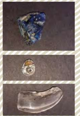
Zlomek modrého skla, zmetek vinutého korálku z čirého skla s vmísenou nečistotou a odštípek z čirého skla, pravděpodobně z výroby tabulového skla. Zaniklá sklárna Bošovice, k. ú. Staré Nespěřice, v provozu 1708 až konec 20. let 18. století. Foto: J. Čáni, 2020
