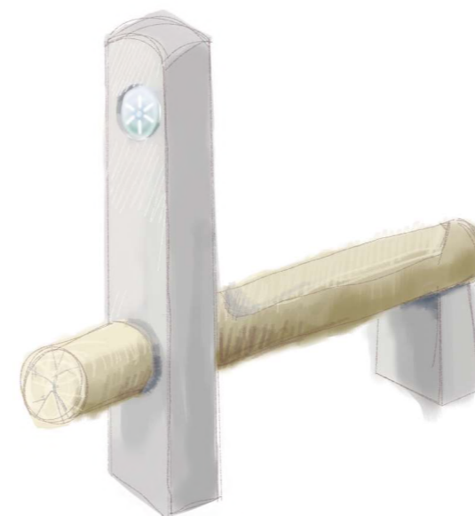
Lavička s betonovým sloupkem pro 2.
