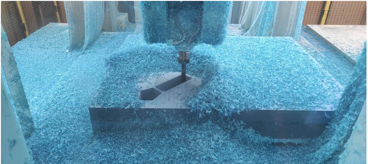
Obrázek 22: Proces obrábění bloku umělého dřeva, modelové zařízení 2635
