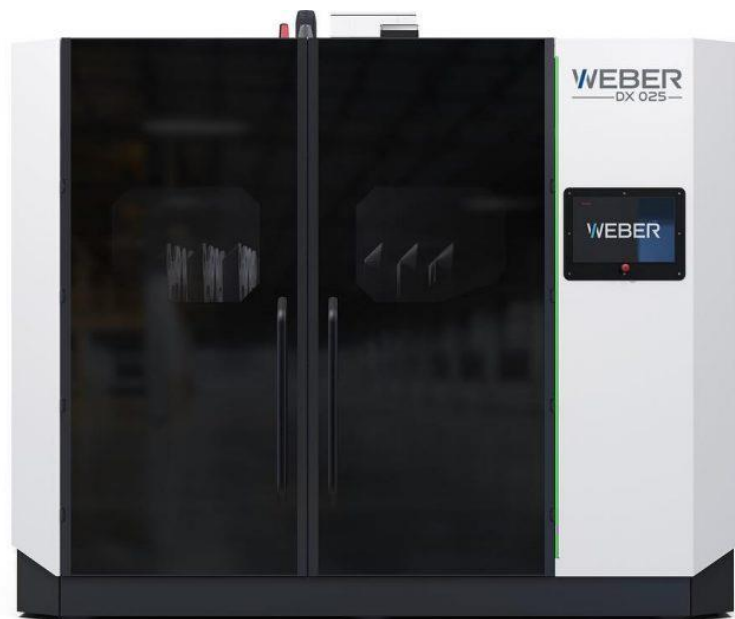
Obrázek 8: 3D tiskárna od firmy Hans WEBER s maximálními rozměry výtisku 1600x1200x1300 mm, převzato z lit. [6]
