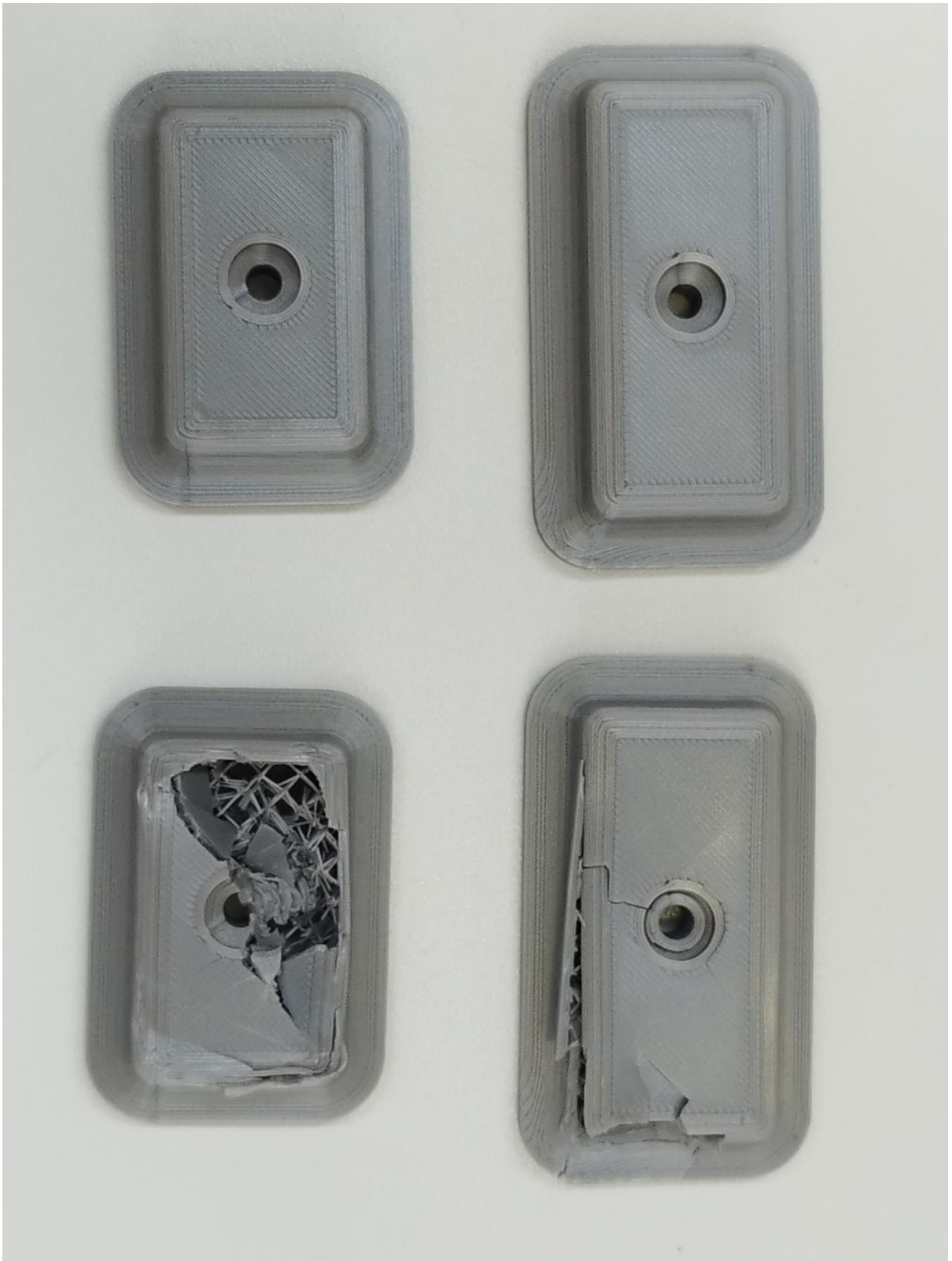
Obrázek 18: Prvky modelového zařízení 9487, nahoře nově vytištěné, dole poškozené
