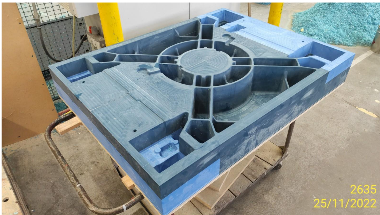
Obrázek 23: Obrobená část modelu z umělého dřeva, modelové zařízení 2635
