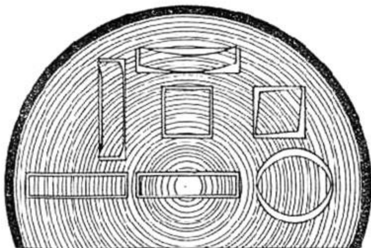
Obrázek 5: Dřevěné výřezky z částí kmene a jejich borcení, převzato z lit. [10]
