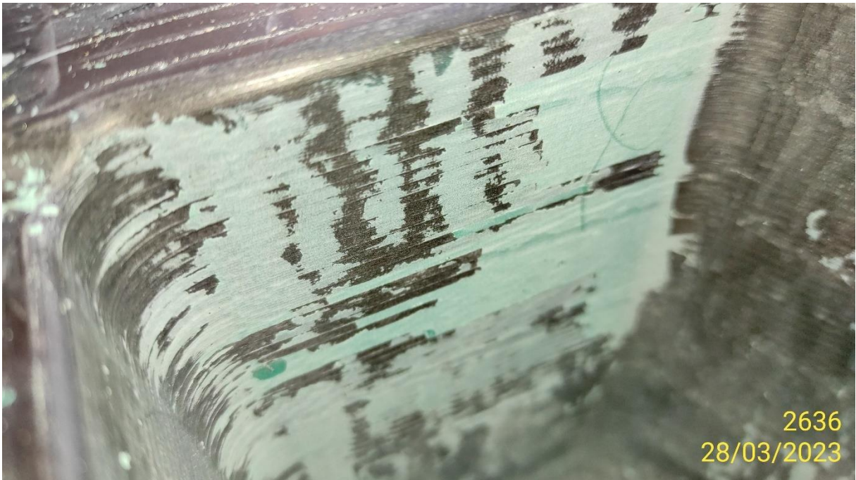
Obrázek 28: Model z 3D tiskárny po ručním kytování, 2636
