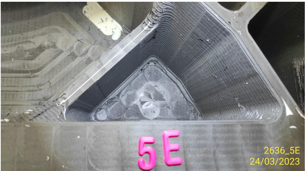
Obrázek 27: Otřep sektoru v 5E od frézy na modelu z 3D tiskárny, 2636
