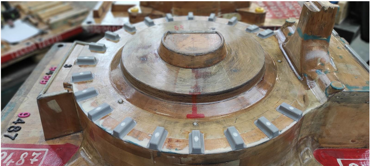
Obrázek 16: Model 9487 po výměně opotřebovaných dřevěných prvků za prvky z PLA
