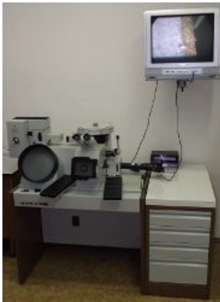
Obrázek 5.15: Mikroskop s adaptérem na fotoaparát Nikon [4]
