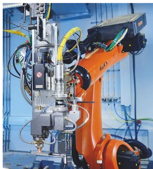
Obr. 13: Robot s technologickou hlavou pro laserové navařování [60]
