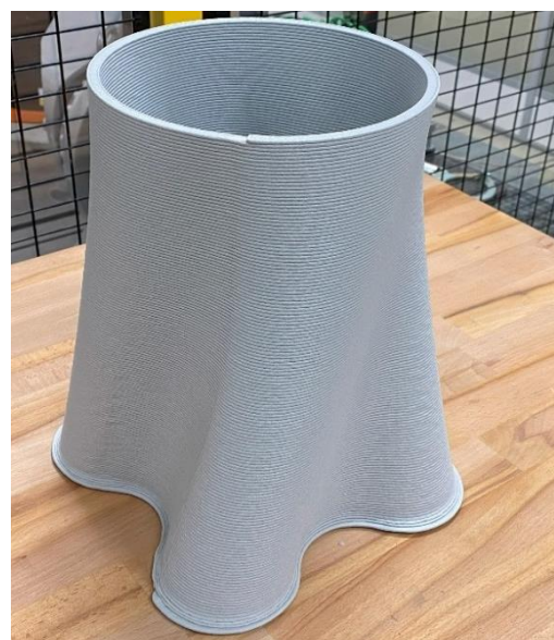
Obr. 92: Dílec s rozdílnými délkami vrstev
