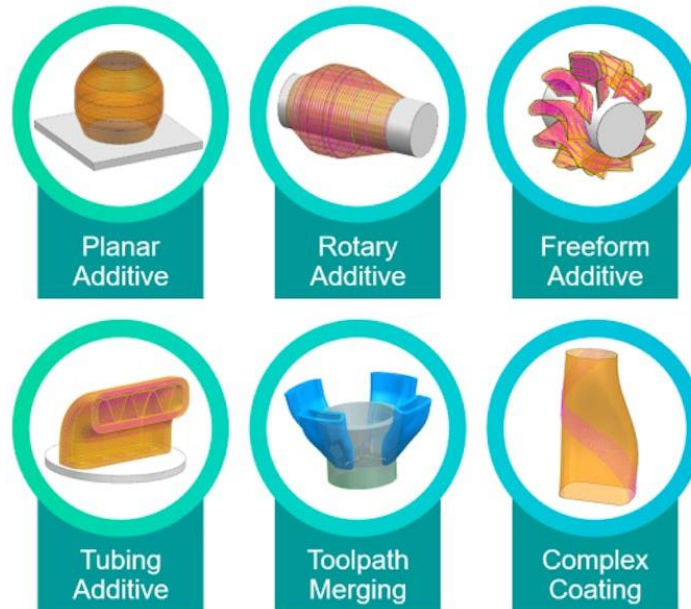
Obr. 30: Zkrácený přehled dostupných technologických operací z kategorie Multi Axis Deposition v Siemens NX [42]
