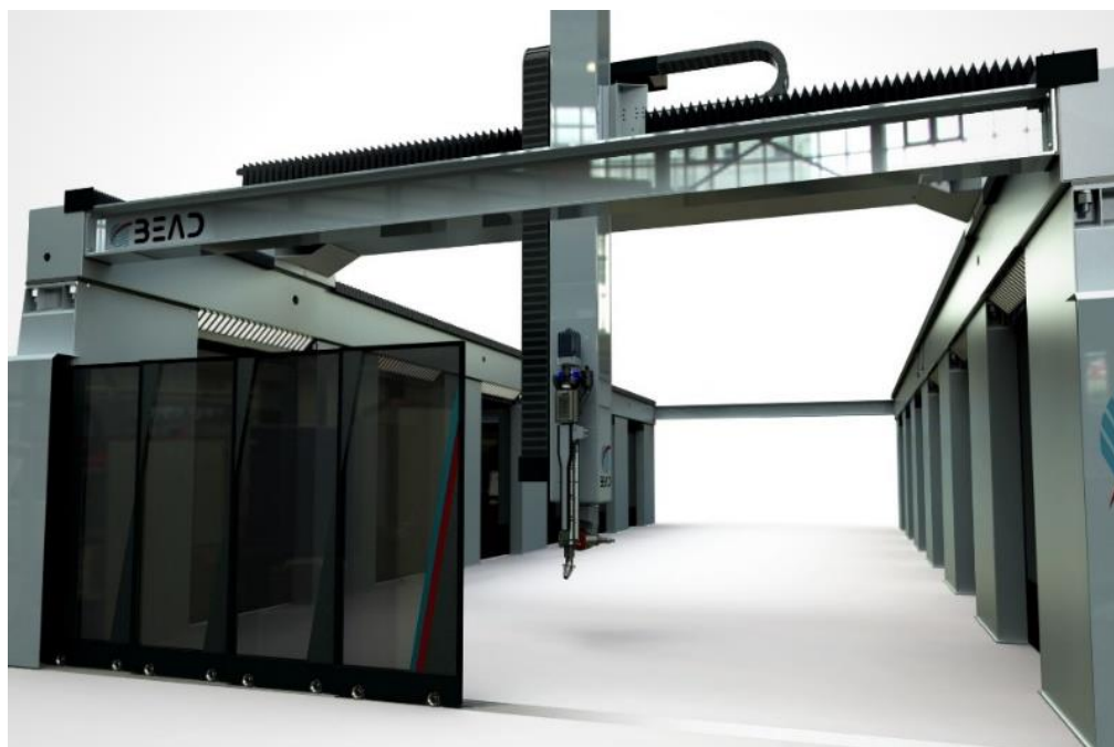
Obr. 22: Portálový stroj BEAD od výrobce Belotti a CEAD pro hybridní výrobu [36]
