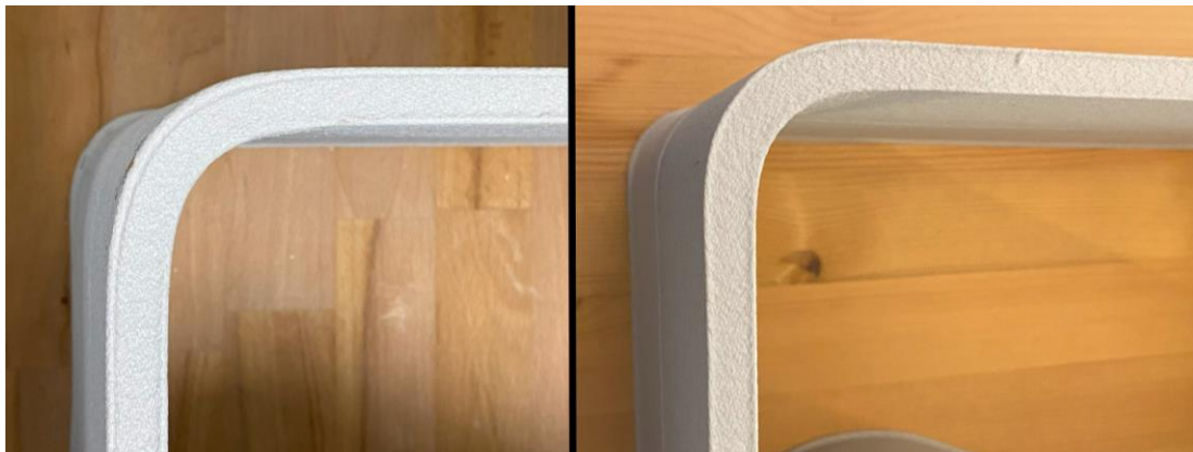
Obr. 91: Porovnání rohu výtisku vlevo konvenčně a vpravo s optimalizační funkcí
