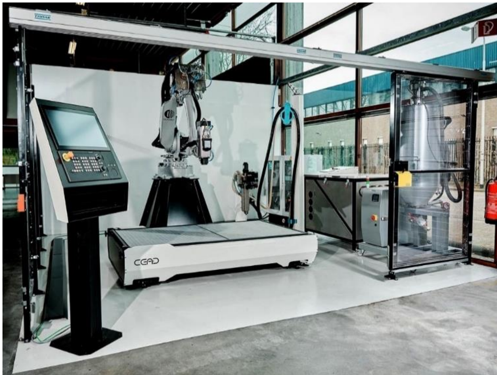
Obr. 14: Pracoviště hybridní polymerní výroby [23]
