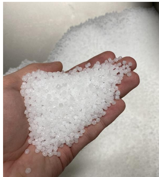
Obr. 21: Vstupní materiál pro extruder – pelety (granulát) HDPE
