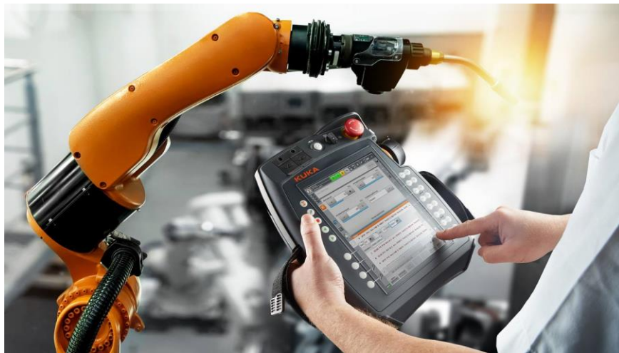
Obr. 24: Robot a příruční panel (teach pendant) KUKA [39]
