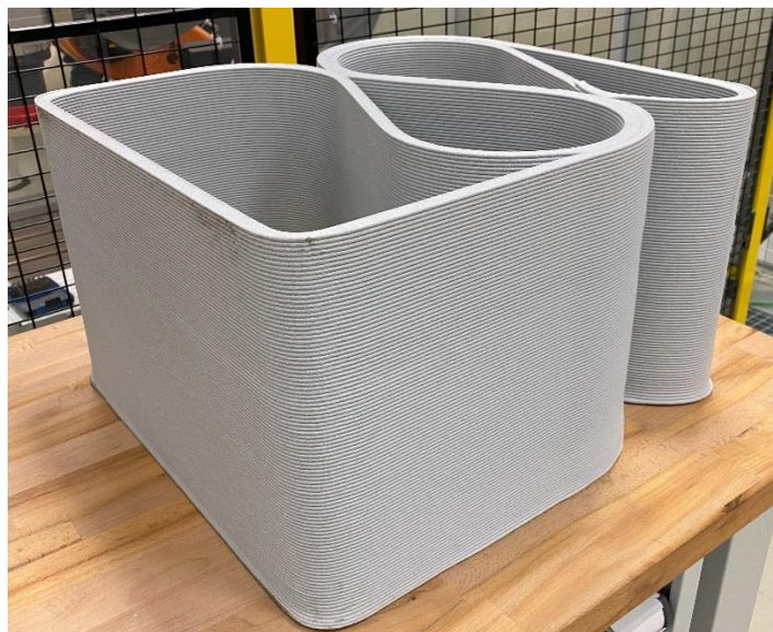
Obr. 90: Stolek vytištěný na pracovišti
