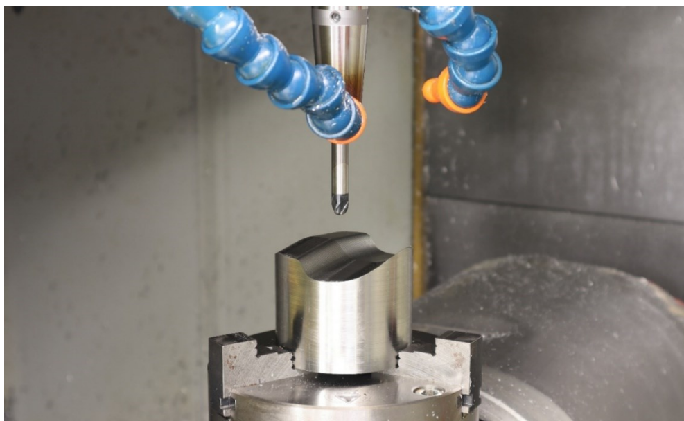
Obr. 68 Fotografie nástroje a dílce upnutého na stroji po dokončení tvarové plochy
