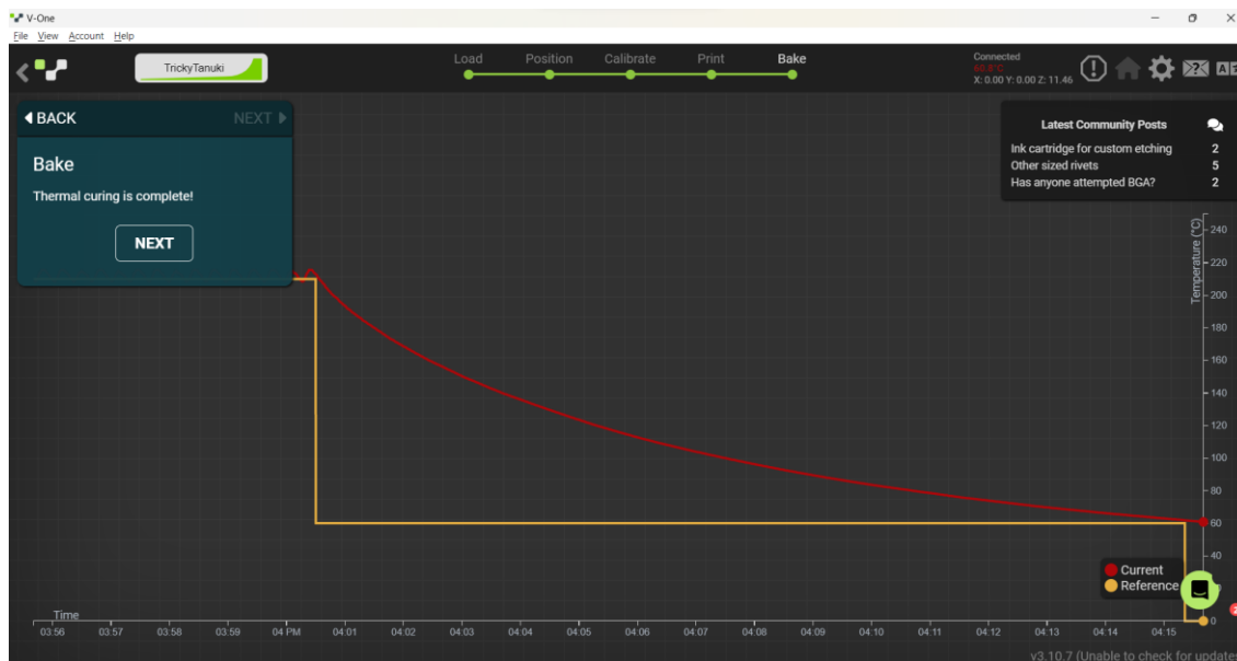
Obrázek 3 - závislost teploty na čase – konec vytvrzování
