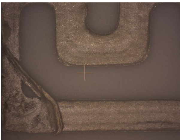
Obrázek 28: zakřivení cest motivu č. 3 – Voltera
