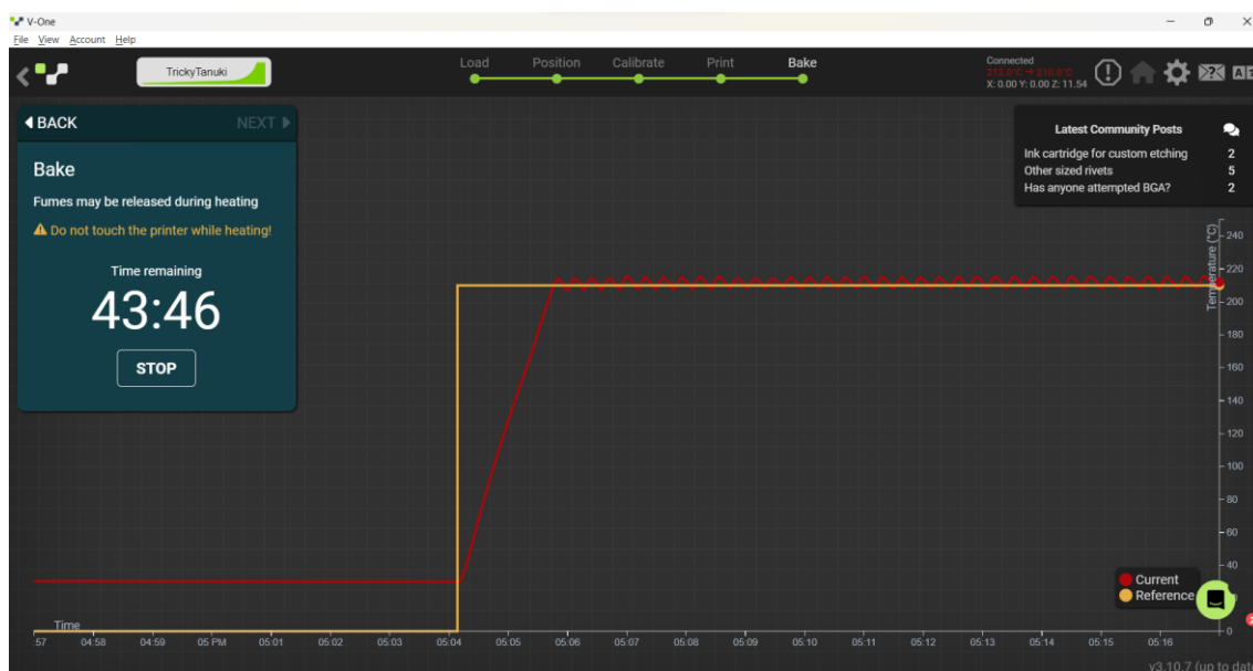
Obrázek 2: závislost teploty na čase – začátek vytvrzování
