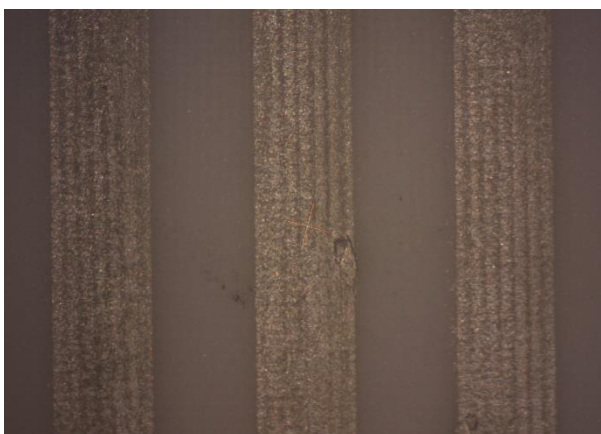
Obrázek 26: málo nanesené pasty – Voltera
