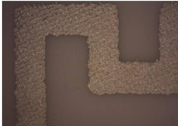
Obrázek 21: typický profil vrstvy nanesené sítotiskem
