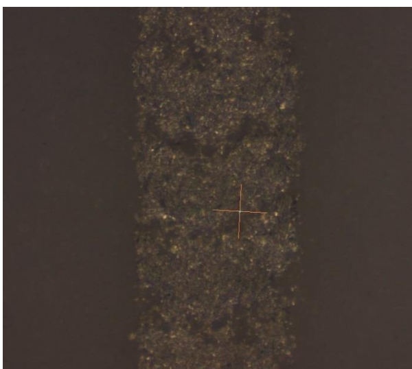
Obrázek 24: nespojená cesta 9-10 motivu č. 1 – Voltera
