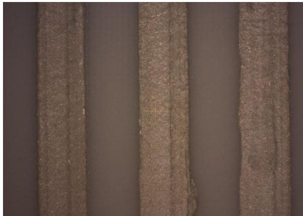
Obrázek 22: typický profil vrstvy nanesené Volterrou
