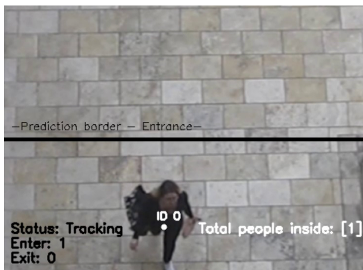
Obr. 18: Snímek z kamery. Počítání lidí pomocí metody průchodu hranice oblasti. [36]
