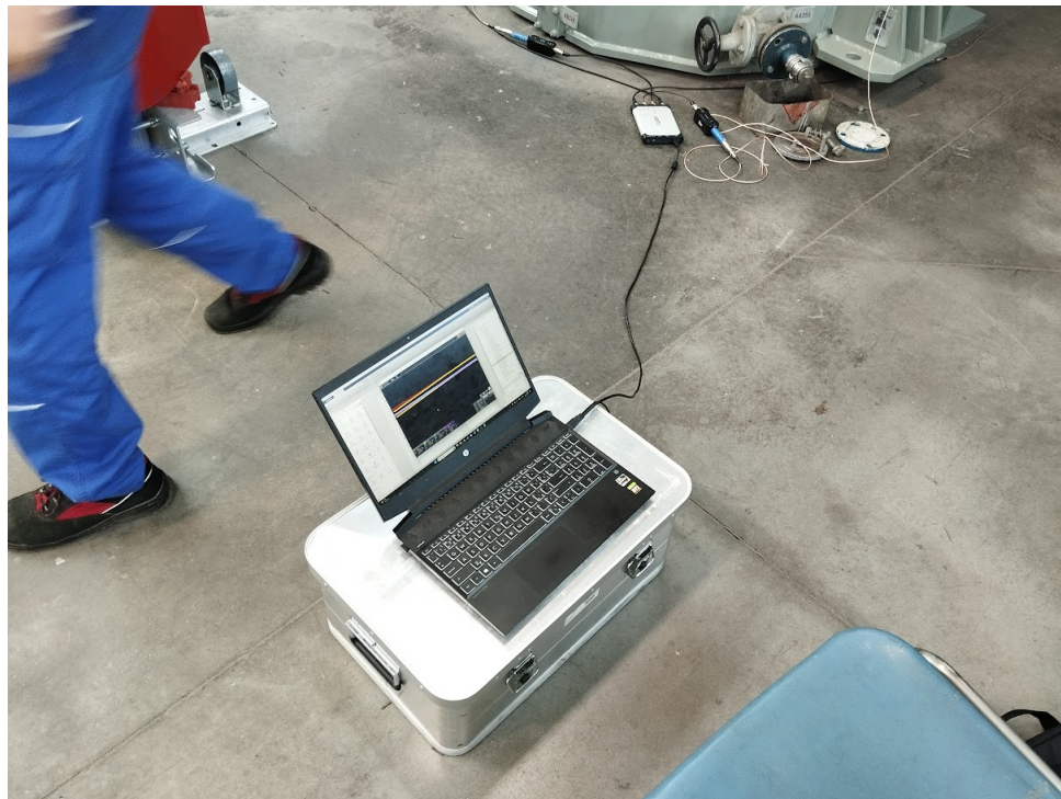
Obrázek 5.22: Měřicí systém - záznamová jednotka se zesilovači a laptopem pro záznam hodnot
