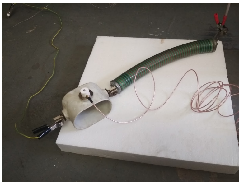
Obrázek 5.2: Testovací sestava pro testování odezvy na vzduchu
