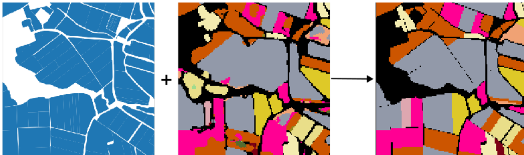
Obr. 3.4: Navrhované zjednotenie top-1 predikcie na základe vektorových dát LPIS. Prvý obrázok zľava reprezentuje vektorovú masku parceli resp. DPB, ďalším je samotná top-1 predpoveď modelu pričom ich spojením získame zjednotenú predikciu na úrovni parceli.
