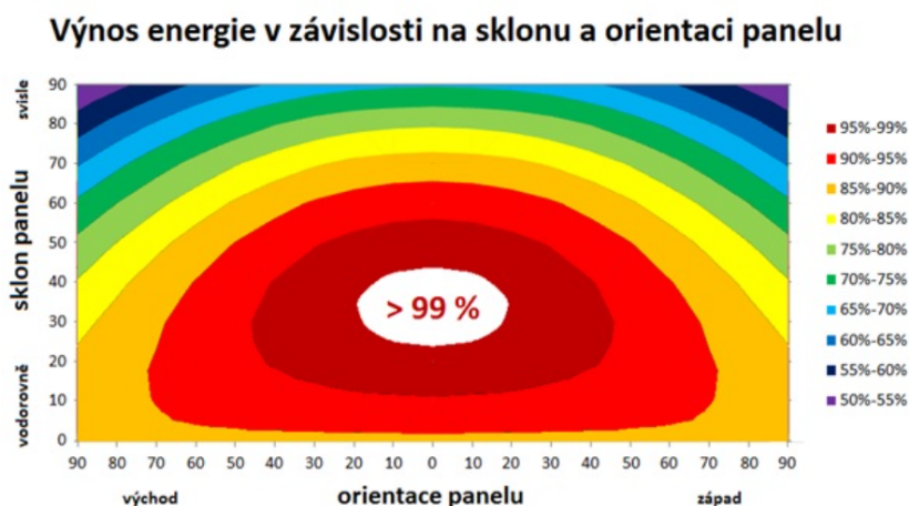
Obrázek 4.3: Výnos energie fotovoltaických panelů v závislosti na natočení a sklonu modulu. Sklon panelů na svislé ose je uveden ve stupních [°] vzhledem k vodorovné ploše. Na ose x je zobrazena odchylka od jižní orientace panelu opět vyjádřena ve stupních [°]. Zbarvení grafu poté zobrazuje procentuální úbytek výkonu panelu při dané orientaci [%]. Zdroj: [35]
