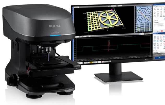
Obr. 27 – Laserový konfokální mikroskop Keyence VK-X [71]
