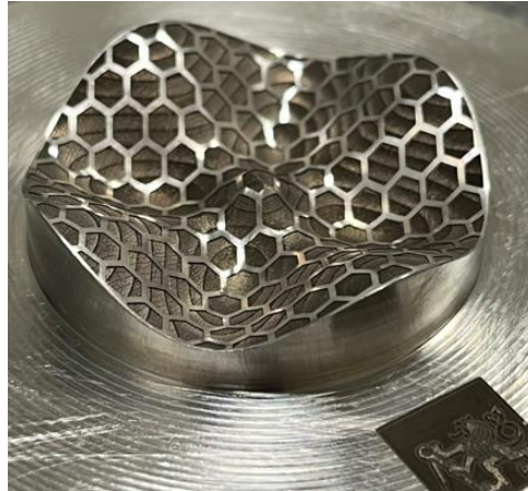
Obr. 45 – Testovací dílec s texturou šestiúhelníků
