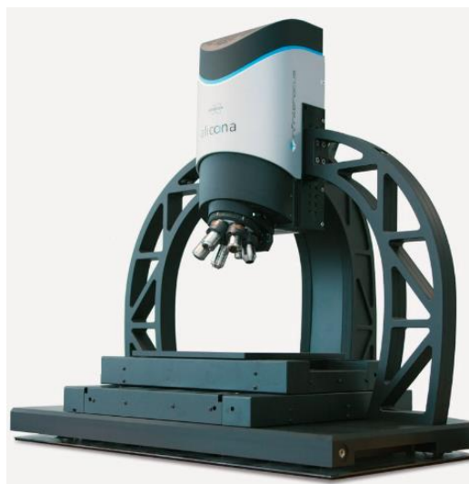
Obr. 28 - Optický mikroskop Alicona InfinityFocus G5 [72]
