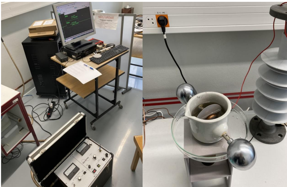
Obrázek 30: Fotografie HV zdroje připojenému k počítači (vlevo) a vzorku připevněném mezi elektrodami (vpravo).
