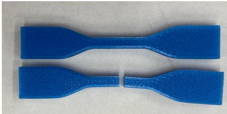
Obrázek 25: Vzorek pro zkoušku v pevnosti v tahu před a po zkoušce.
