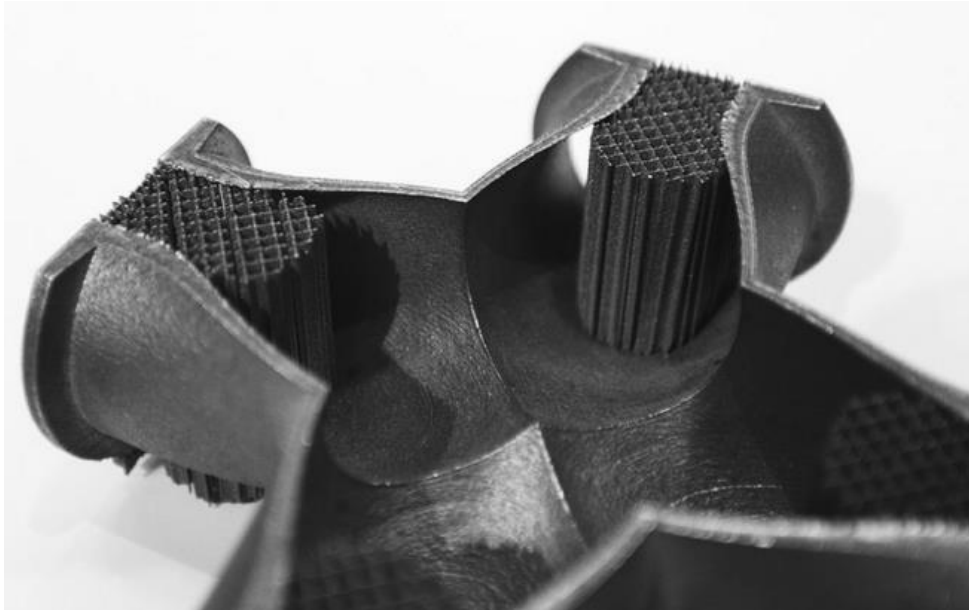
Obrázek 7: Součástka vyrobená pomocí technologie SLM [2].
