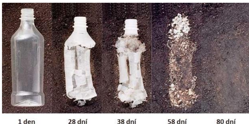
Obrázek 19: Vizuální průběh biodegradace PLA kompostování při zvýšené teplotě a vlhkosti prostředí [21].
