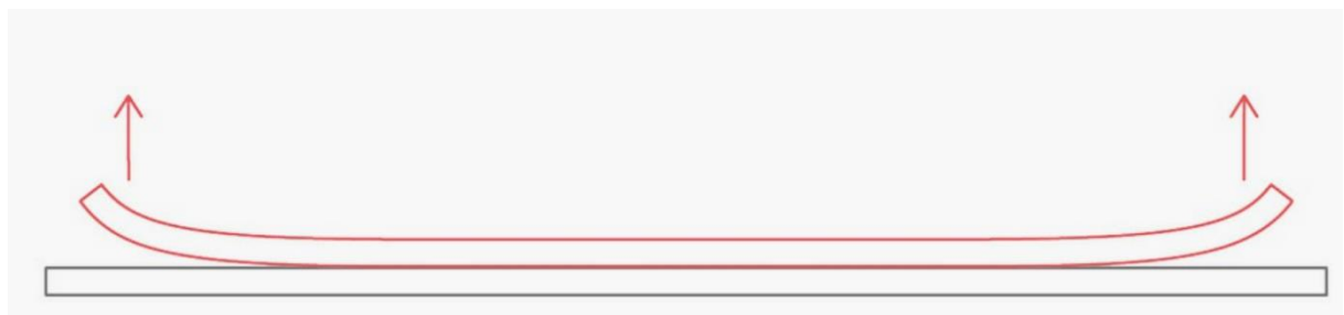
Obrázek 13: Ukázka možného kroucení tištěného materiálu vlivem teplotních rozdílů [2].
