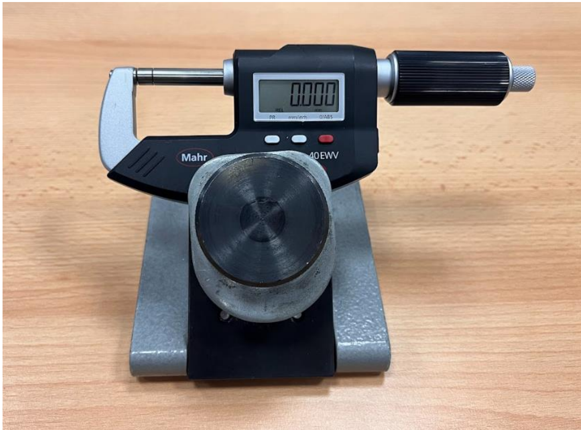
Obrázek 9 Mikrometr Mahr upevněný ve stojanu
