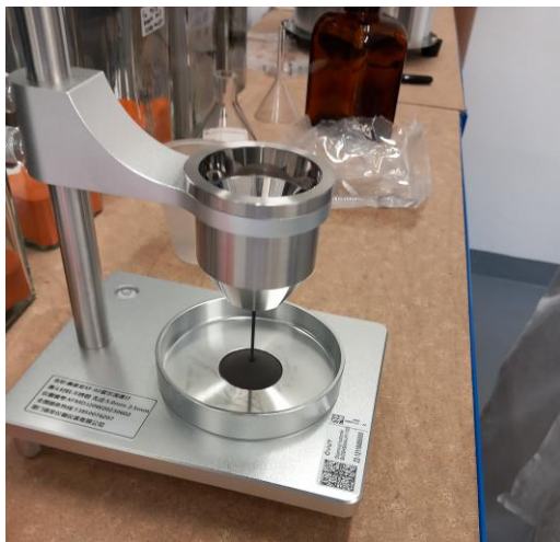
Obr. 7.2: Flow test prášku
