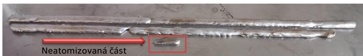
Obr. 7.1: Polotovár slitiny TiCrNb
