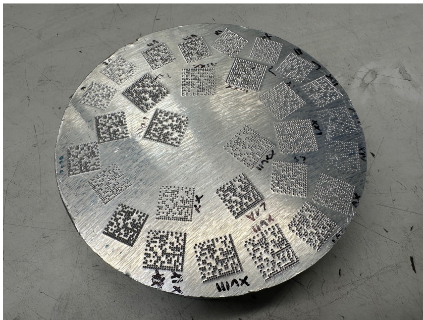
Obr. 34 - první označený díl s různými parametry ražení
