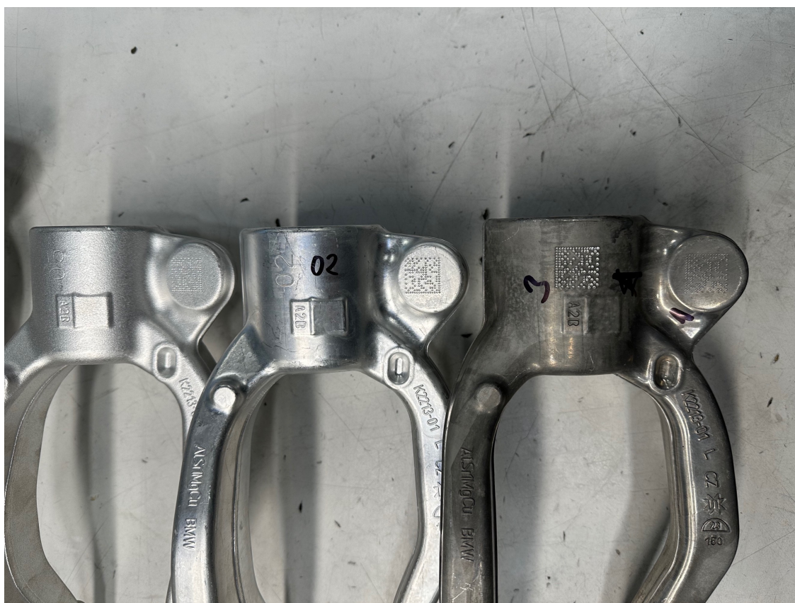
Obr. 41 - zprava doleva – původní, mořeno, otryskáno
