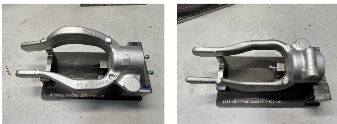
Obr. 37 - ukázka založení dílu do přípravku
