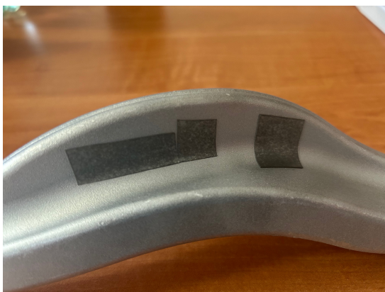
Obr. 72 - DMC po tryskání (vlevo zakrytý páskou, vpravo bez pásky)
