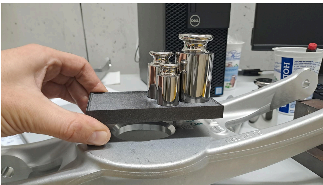
Obr. 59 - způsob testování mechanického opotřebení
