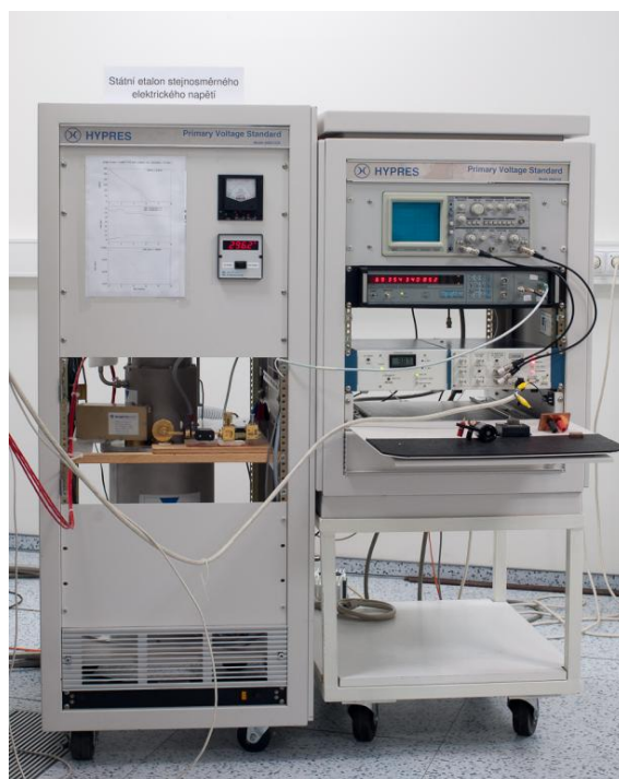
Obrázek 1.10: Státní etalon stejnosměrného elektrického napětí [11]
