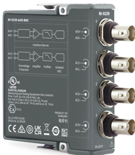
Obrázek 2.3: Modul pro sběr dat NI-9239 [20]
