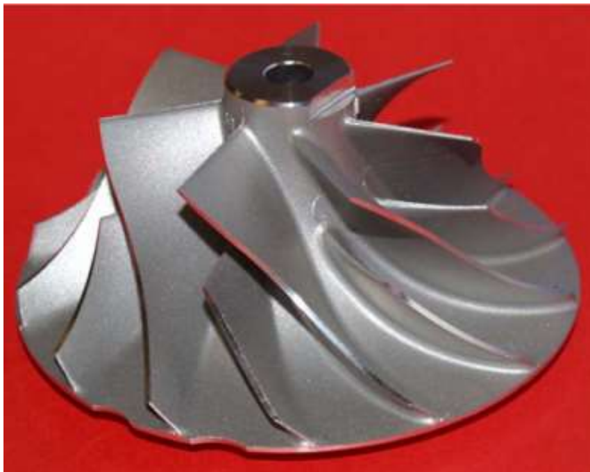
Obrázek 6: Kompresorové lopatkové kolo turbodmychadla o průměru 85 mm vyrobené ze slitiny hliníku metodou semi – solid casting [13]
