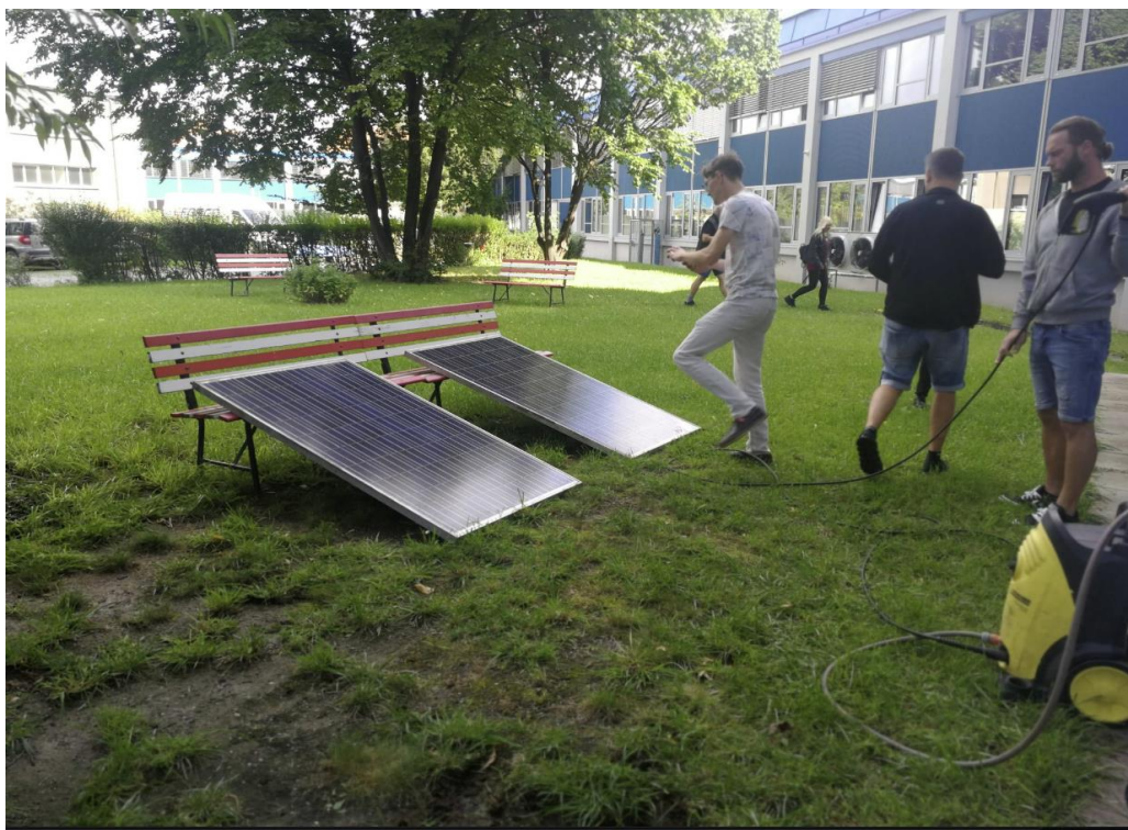
Obrázek 5. Fotodokumentace čištění fotovoltaických panelů.
