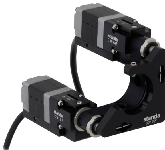
Obrázek 3.6: Kinematický držák zrcadla 8MBM24-1-2. Převzato z [22].
