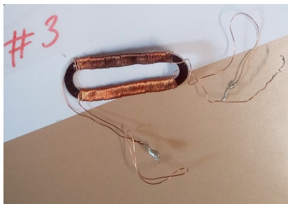
Obrázek 3.4: Vytištěný senzor z inkoustu I2 s navinutou budící cívkou.
