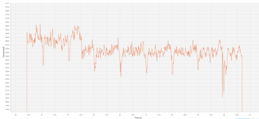
Obrázek 5.9: Průměrná hodnota odebíraného proudu v aktivním módu je 8,65mA.
