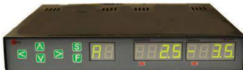
Obr. 2.3 Kontrolér Spid Elektronik Rot2Prog
