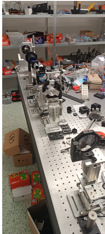
Obr. 4.2: Fotografie experimentální soustavy upravující profil laserového paprsku z konce s kamerou. Na fotografii není kamera s mikroskopickou optikou.
