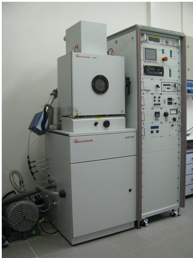
Obrázek 2.3: Vakuová napařovací komora Edwards 500
