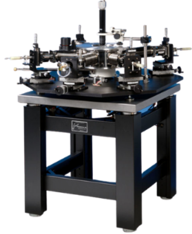
Obrázek 3.2: Sondová stanice Janis Research ST-500 na stolku s pneumatickým tlumením vibrací [41]
