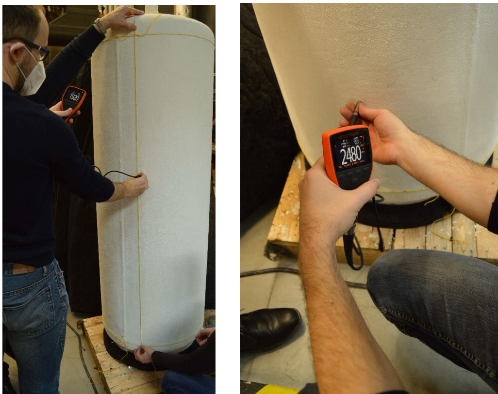
Obr 28: Měření tloušťky naneseného tenkovrstvého izolačního nátěru, Zdroj: fotoarchiv autora
