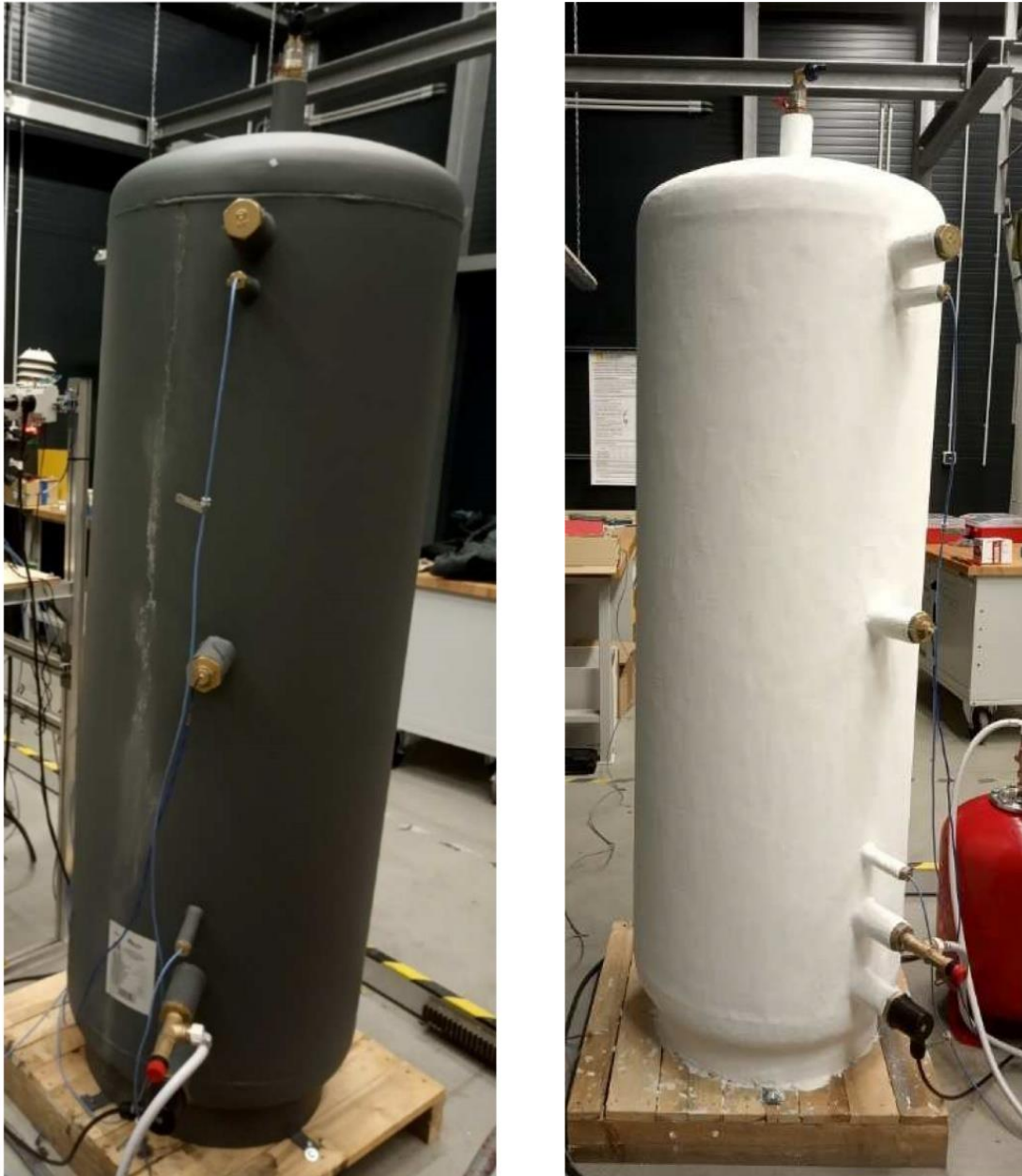
Obr 23: Zásobníky tepla – vlevo model A bez izolace, vpravo model B s 2 mm izolačního nátěru, Zdroj: UCEEB ČVUT
