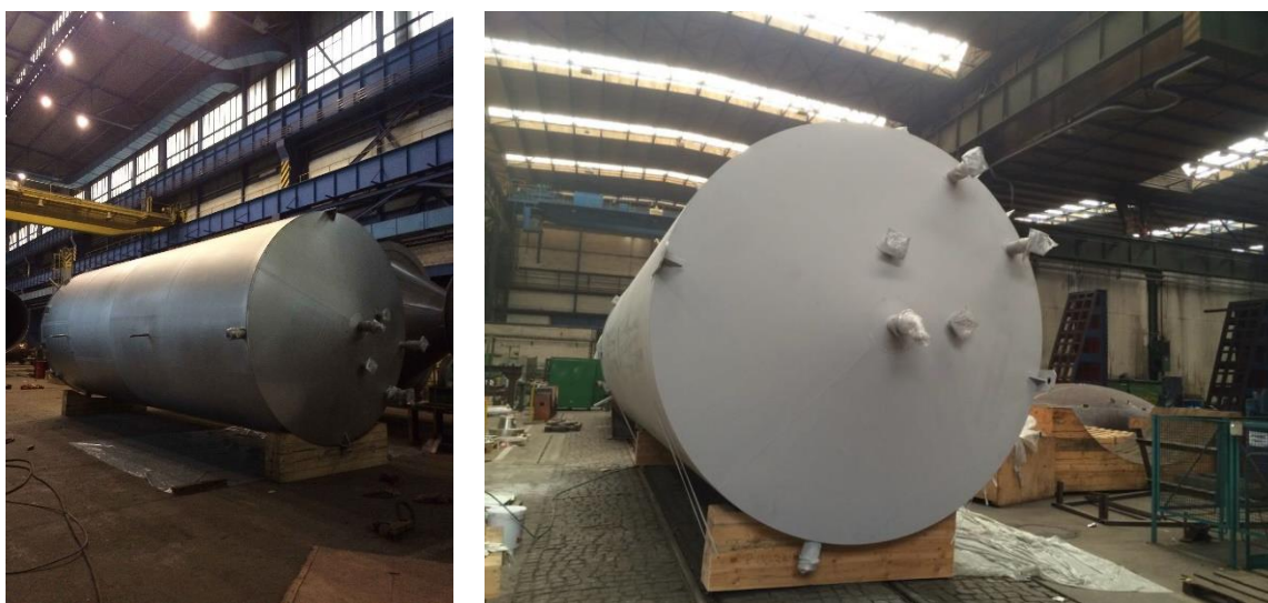
Obr 56: Nádrž na vodu ve společnosti ZVU STROJÍRNY, a.s., vlevo před aplikací termoizolační hmoty, vpravo po aplikaci, Zdroj: ADITEX, spol. s r.o.
