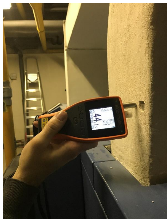
Obr 50: Měření povrchových teplot na kouřovodu v technické místnosti bytového domu v Praze, Zdroj: fotoarchiv autora
