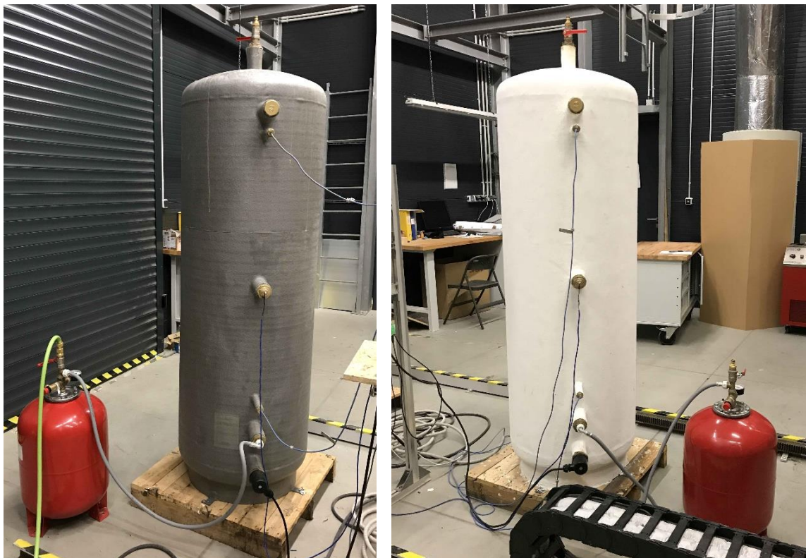
Obr 31: Zásobníky tepla se stejnou izolační vrstvou 2 mm, vlevo s Mirelonem, vpravo se zkoumanou nátěrovou hmotou, Zdroj: fotoarchiv autora
