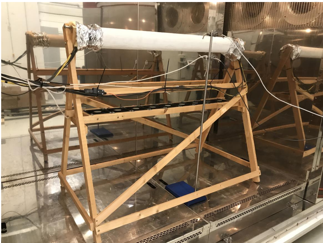
Obr 34: Experimentální zařízení s izolovaným potrubím v klimakomoře, Zdroj: fotoarchiv autora
