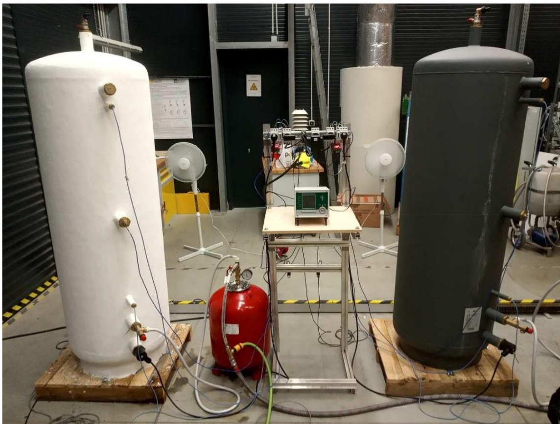
Obr 29: Pohled na experimentální trať pro měření tepelných ztrát zásobníků tepla během nucené konvekce vzduchu, Zdroj: UCEEB ČVUT
