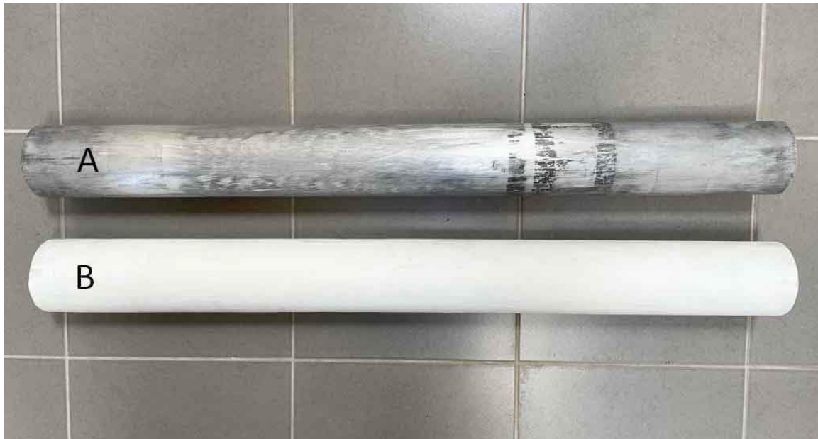
Obr 32: Zkušební vzorky, A – hliníková trubka bez jakékoliv tepelné izolace, B – hliníková trubka s tenkovrstvou izolační hmotou o tloušťce 2mm, Zdroj: fotoarchiv autora
