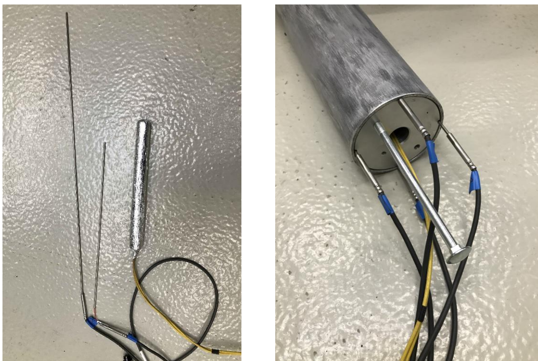
Obr 35: Vlevo - teplotní čidla a elektrická topná patrona, vpravo – čidla s patronou zasunuta do části experimentálního zařízení, Zdroj: fotoarchiv autora
