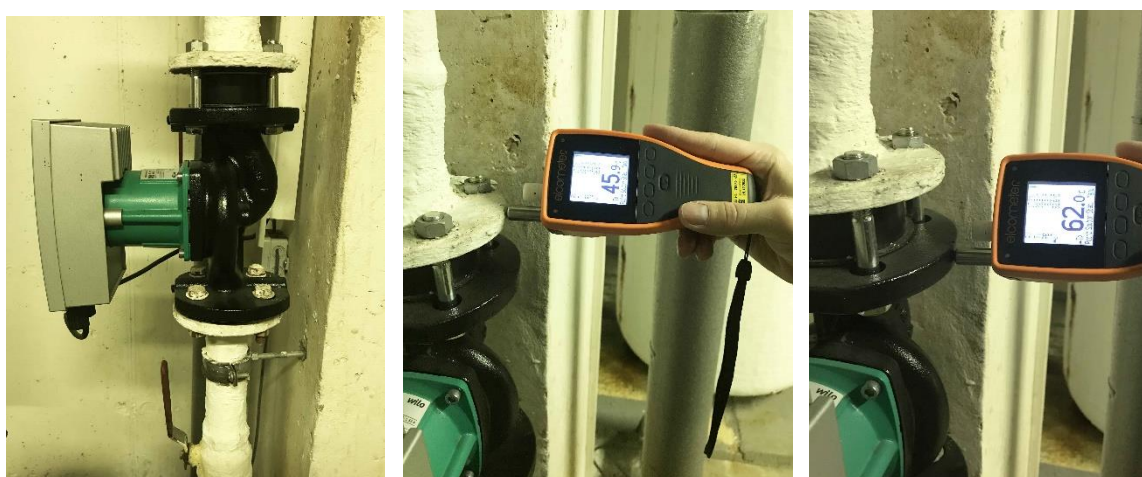
Obr 48: Měření povrchových teplot na rozdělovači-sběrači technické místnosti bytového domu v Praze, Zdroj: fotoarchiv autora
