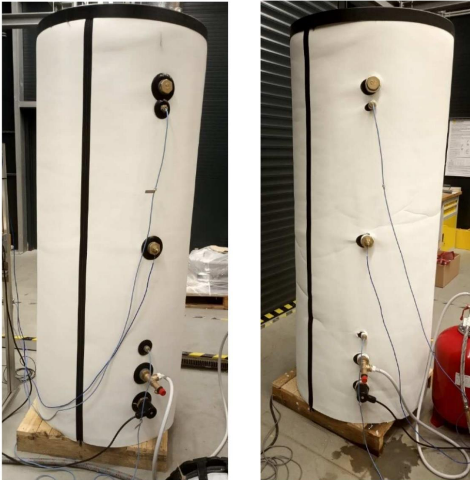
Obr 24: Zásobníky tepla – vlevo model C s klasickou 100 mm fleecovou izolací pokrytou bílou koženkou, vpravo model D jako kombinace předchozích modelů B+C, Zdroj: UCEEB ČVUT
