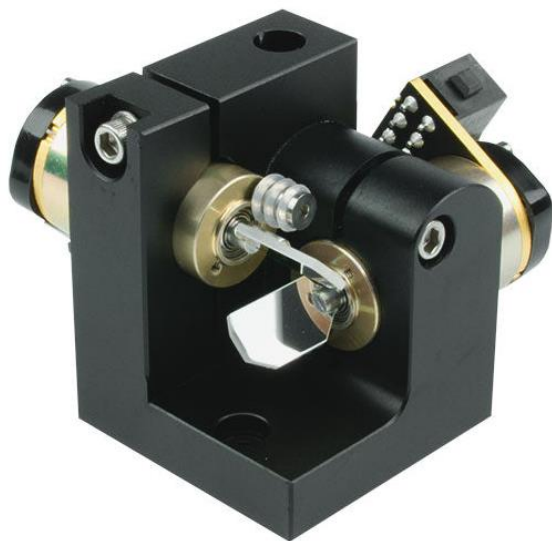
Obrázek 5: Uspořádání galvomotorů pro dvojrozměrné skenování [11]
