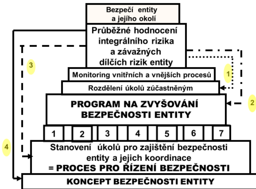
Obr. 12. Procesní model řízení bezpečnosti entity v čase. Procesy: 1- koncepce a řízení; 2 - administrativní postupy; 3 - technické záležitosti (technická problematika entity a jejího okolí); 4 - vnější spolupráce; 5 - nouzová připravenost; 6 - dokumentace a šetření havárií; a 7 - zabezpečení entity – zpracováno dle [24].
