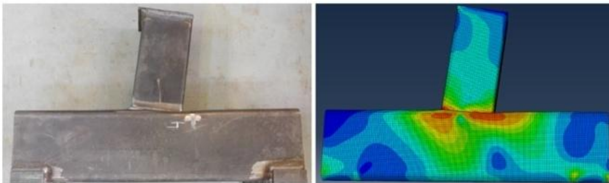
Obr. 65 – Validace deformovaného tvaru styčnicku TB.1.A
