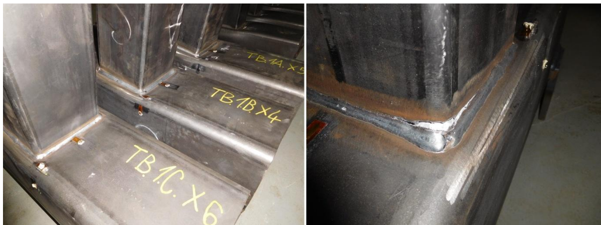
Obr. 51 – Deformované vzorky zatížené ohybem ve své rovině po provedení experimentu
