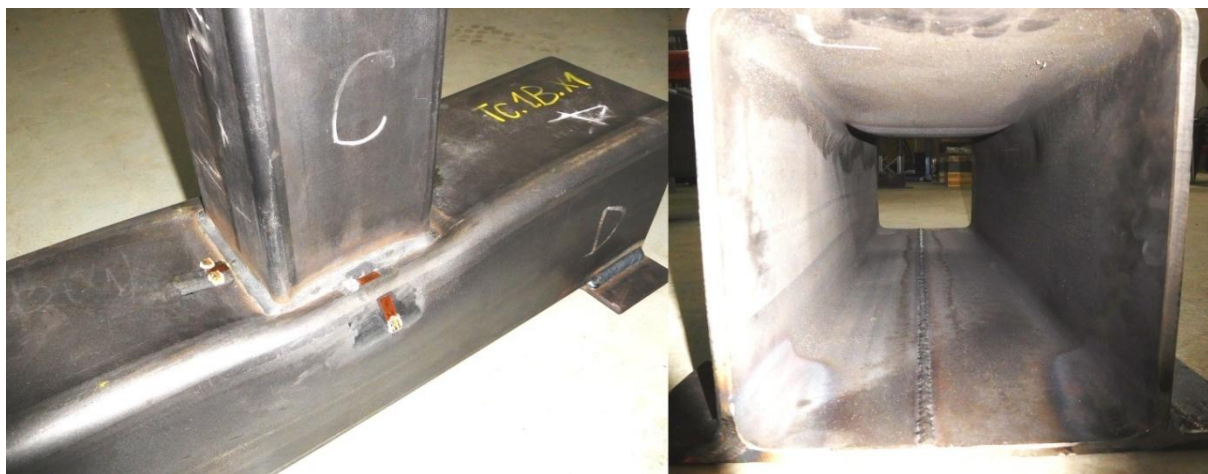
Obr. 48 – Deformovaný vzorek TC.1.B po provedení experimentu
