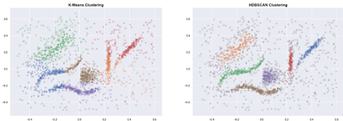
Obr. 15 Ukázka rozdílu mezi K-means a HDBSCAN clusterů [39]
