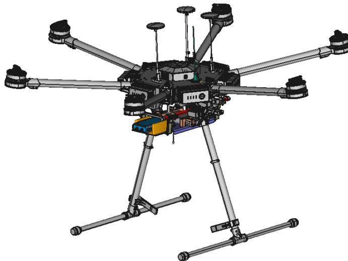
Obrázek 2.6: Kompletní 3D sestava z horního pohledu DJI 600 PRO
