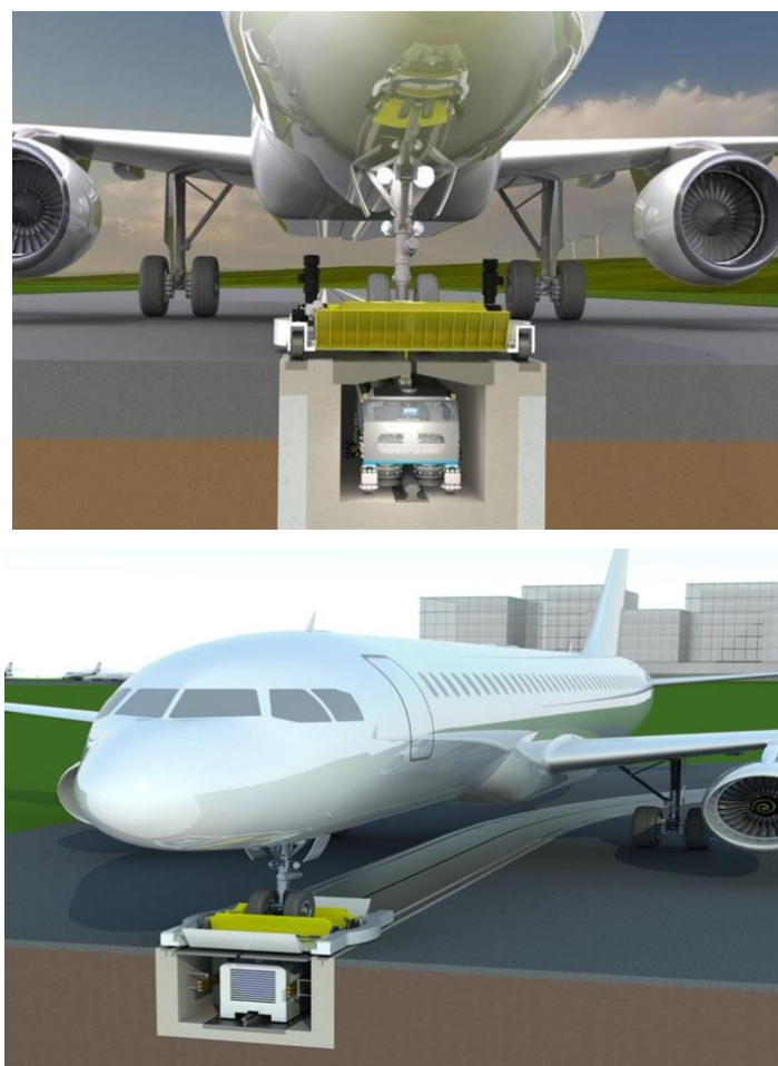
Obrázek 20 - Systém „ATS“ instalovaný uprostřed pojezdové dráhy [16]
