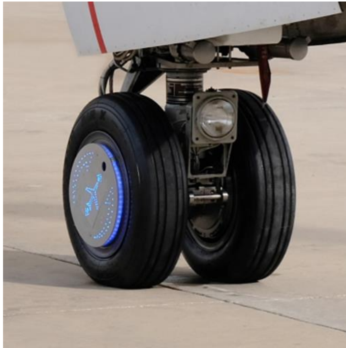
Obrázek 16 - Systém „WheelTug“ instalovaný v předovém podvozku letadla
