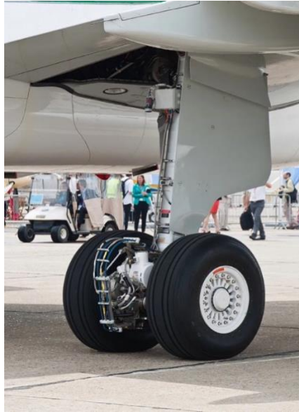
Obrázek 19 - Systém "EGTS" na podvozku letadla A320 [15]
