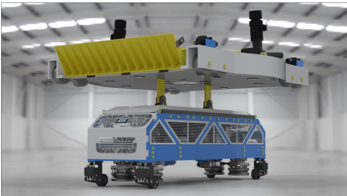
Obrázek 21 - Jeden z vozů „PullCar“ s vozíkem namontovaným nahoře [16]
