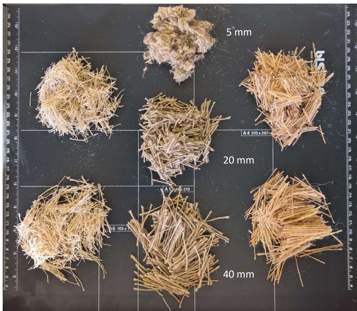
Obrázok 27: Elementy testovaných priadzí. Zľava: konope 100x3 tex, ľan 500 tex a juta 300 tex. Konopná priadza bola zložená z 3 nití s jemnosťou 100 tex. Ich mierny zákrut dovoľoval ľahký rozpad po nastrihaní na požadovanú dĺžku elementov.
