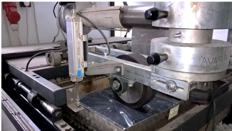
Obrázok 31: Malé skúšobné zariadenie pre skúšku vyjazďovania kolesom.
