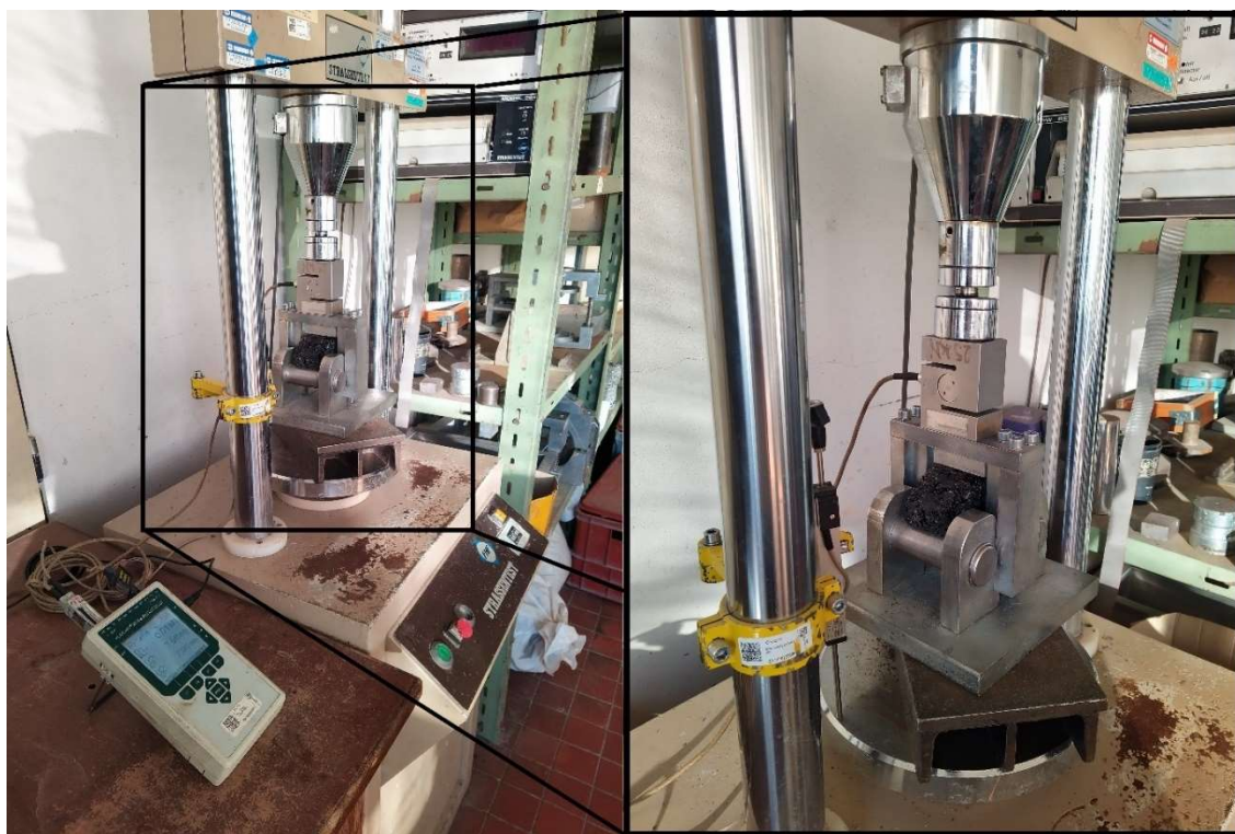
Obrázok 30: Konfigurácia testu odolnosti voči trhlinám.
