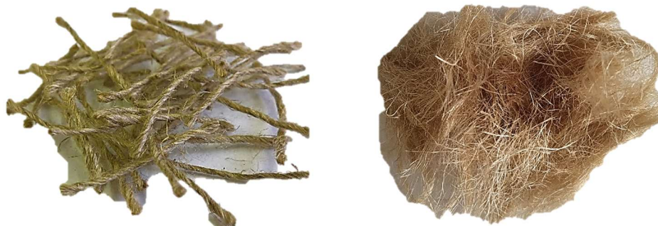
Obrázok 44: Elementy priadze dĺžky 20 mm (vľavo) a jednotlivé vlákna po rozpade prierezu.
