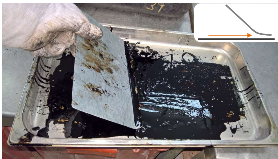
Obrázok 16: Súprava na nanášanie spojiva na priadze a schéma spôsobu nanášania.
