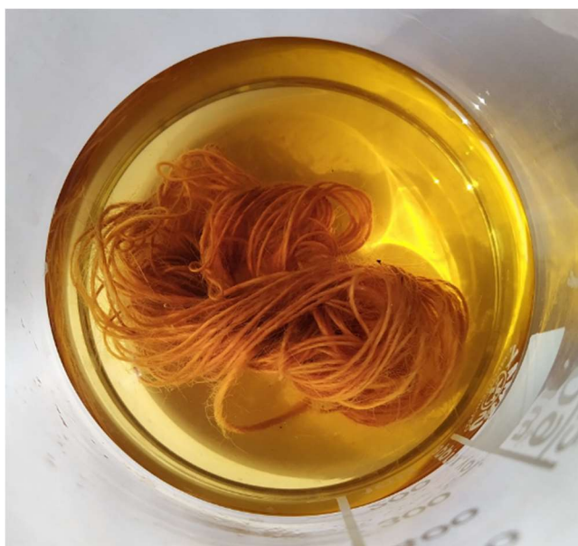
Obrázok 19: Jutová priadza v 10% roztoku NaOH.
