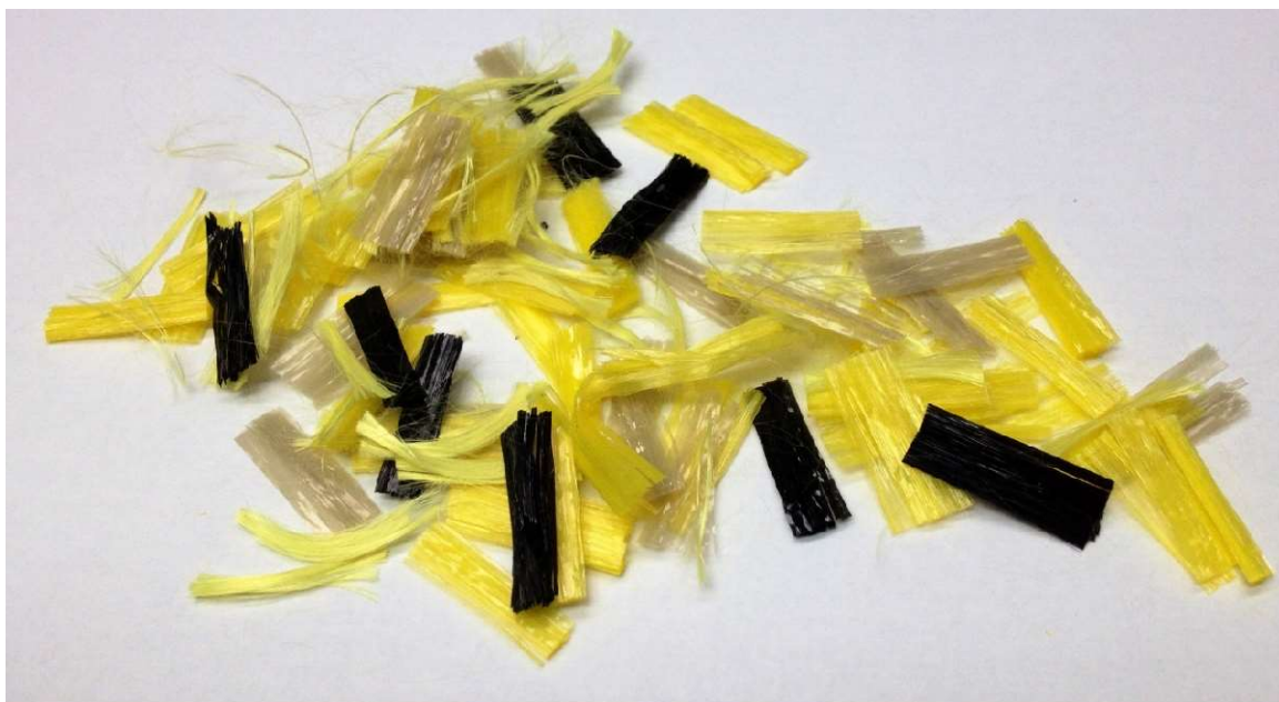
Obrázok 9: Zmes aramidových a polyolefínových vlákien od firmy FORTA®
