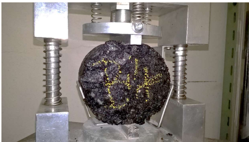
Obrázok 28: Skúšobné čeluste v priebehu skúšky stanovenia pevnosti v priečnom ťahu.
