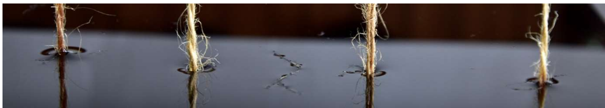
Obrázok 14: Detail testovaných vzoriek v 5. až 10. minúte testu. Zľava: 20% 1h., HF, HF 2% 2h. a ref.
