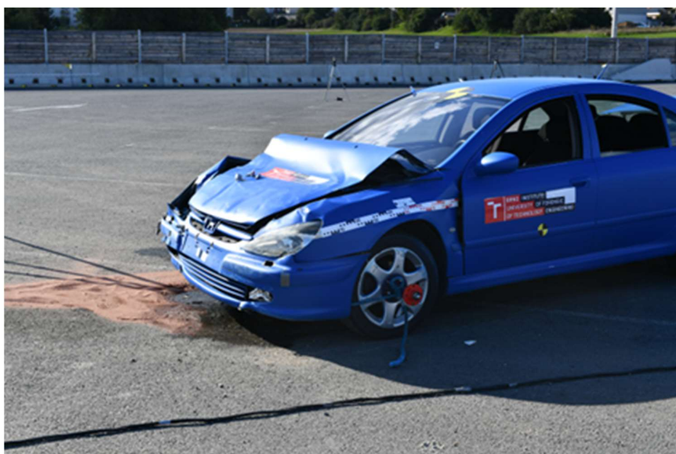
Obrázek 29 Vozidlo Peugeot 607 po crashtestu [ČVUT]
