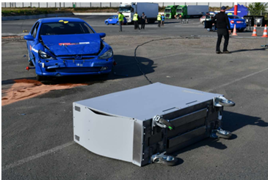
Obrázek 30 Stav makety stanice a vozidla po crashtestu [ČVUT]
