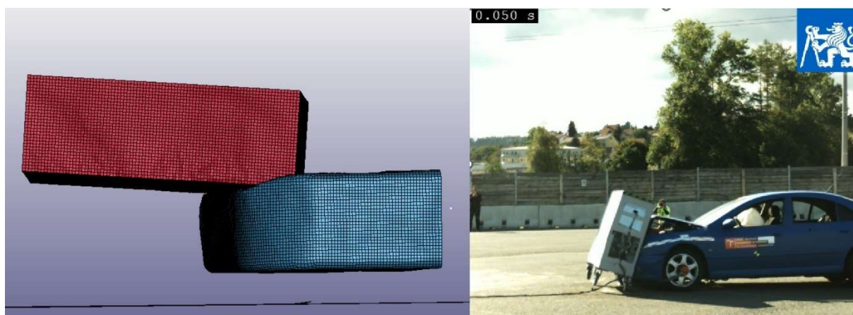
Obrázek 32 Porovnání simulace a videa - čas 50 ms [práce autora, ČVUT]
