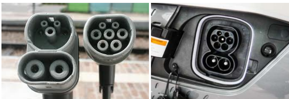
Obrázky B2 a B3: Konektory CCS2 a Mennekes Type 2 a společná zástrčka na vozidle [51]
