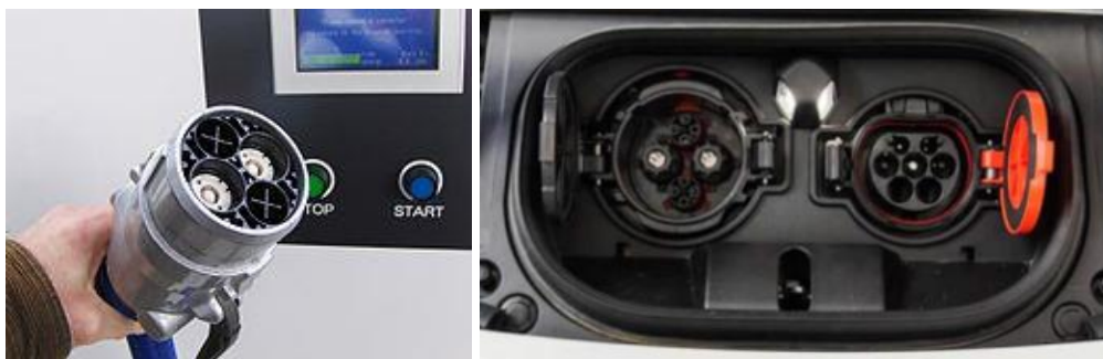
Obrázky B4 a B5: Konektor CHAdeMO a oddělené zástrčky na vozidle [51]
