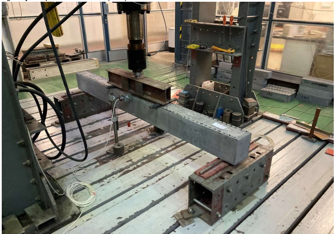
Obrázek 64 – Připravené uspořádání zkoušky s nosníkem krátce před zkouškou
