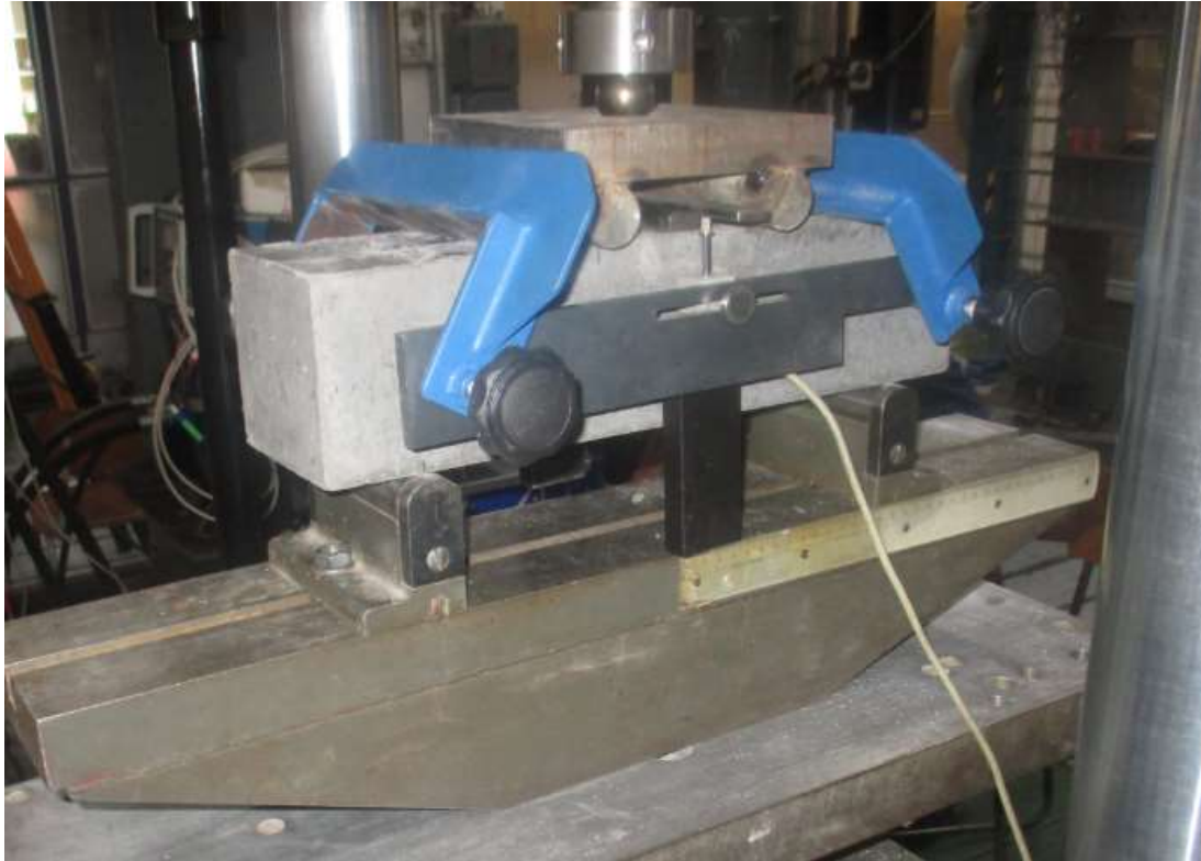
Obrázek 60 – Uspořádání zkoušky ve čtyřbodovém ohybu podle ČSN EN 12390-5
