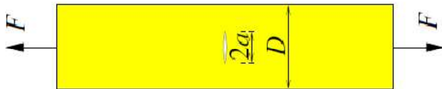
Obrázek 30 – Betonový pásek s trhlinou [26]
