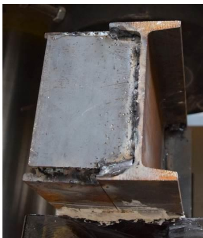
Obr. 8.7: Roznášecí nosníky s přivařenými výztuhami
