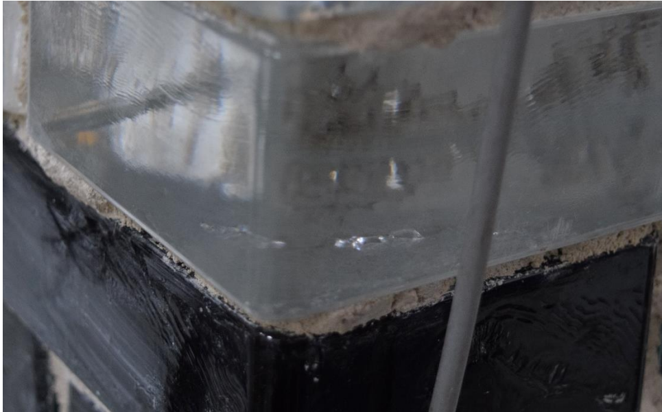
Obr. 8.63: Charakter porušení zaznamenaný při druhém zatěžování
