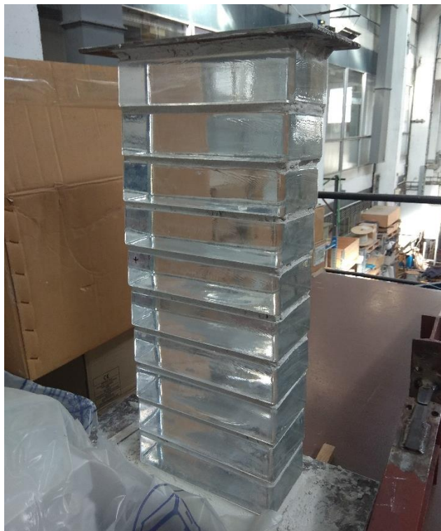
Obr. 8.4: Zkušební těleso C9-03 pro zkoušku v tlaku
