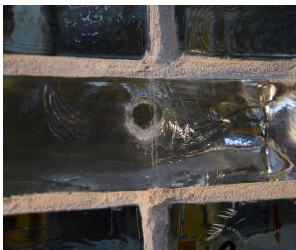
Obr. 8.44: Lokální porušení skleněné cihly v místě nárazu ocelové koule po druhém nárazu
