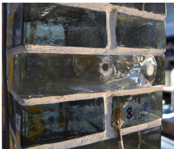
Obr. 8.44: Lokální porušení skleněné cihly v místě nárazu ocelové koule po druhém nárazu
