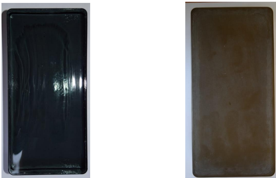
Obr. 7.9: Porovnání cihly bez úpravy (vlevo) a pískované cihly (vpravo)
