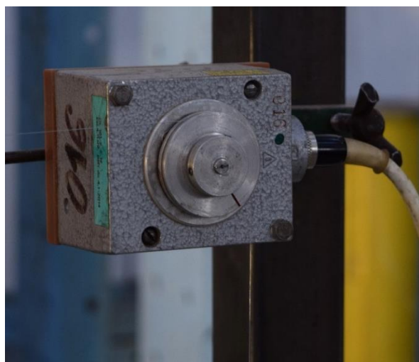
Obr. 8.28: Potenciometrický kladkový snímač dráhy
