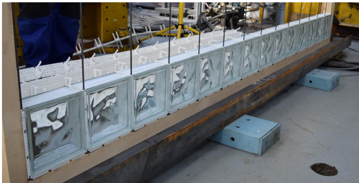
Obr. 5.5: Skleněné tvárnice osazené v systému plastových rámečků a křížů
