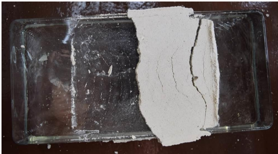
Obr. 7.19: Kombinované kohezně-adhezí porušení
