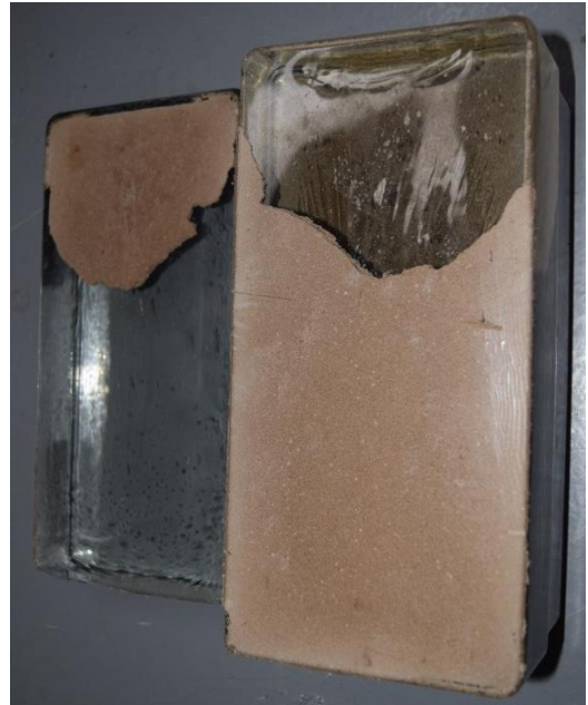
Obr. 7.7: Zkušební tělesa, u nichž došlo k typickému adheznímu porušení (vlevo) a kombinovanému porušení (vpravo)
