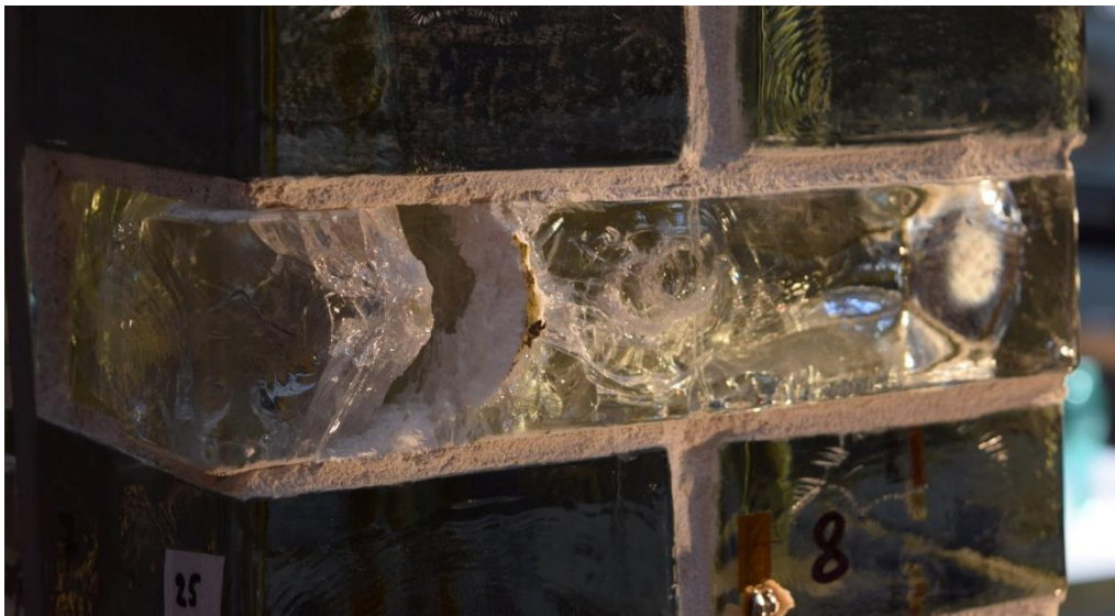
Obr. 8.45: Porušení cihly ve výšce 1525 mm po třech nárazech
