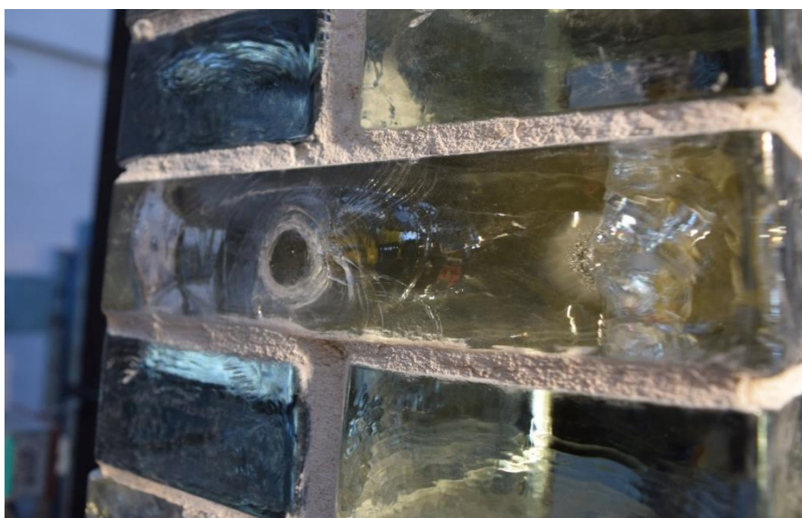
Obr. 8.45: Porušení cihly ve výšce 1525 mm po třech nárazech
