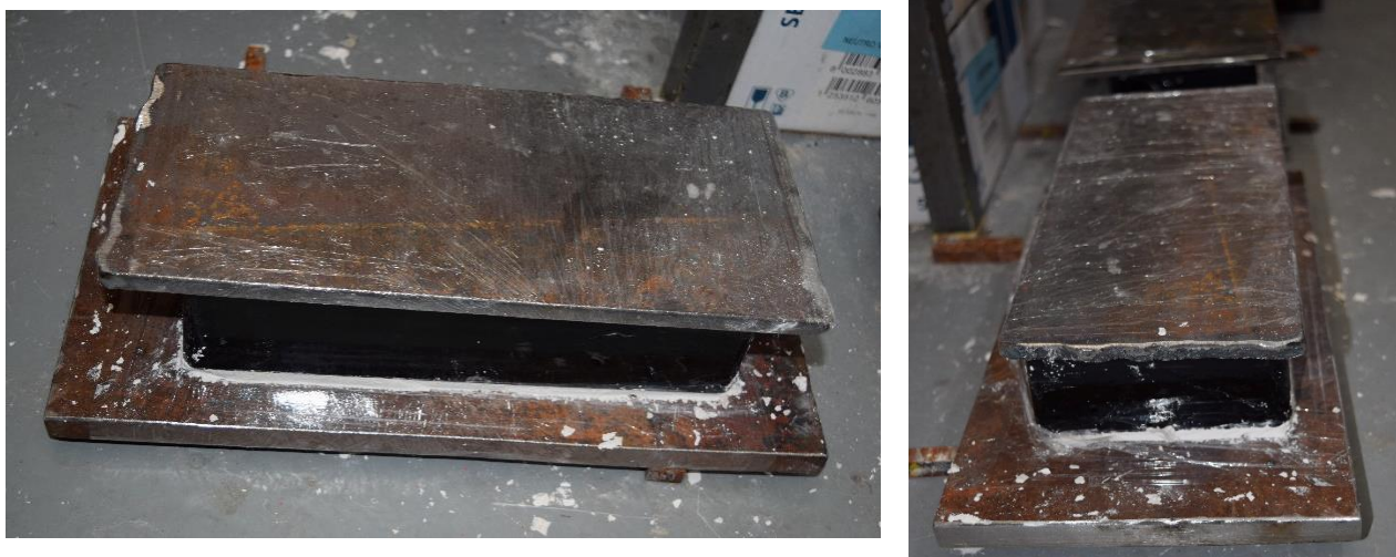
Obr. 7.36: Zkušební těleso pro zkoušky cihel v tlaku
