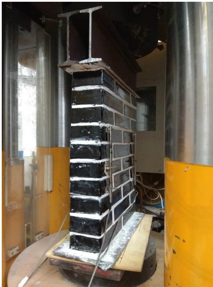
Obr. 8.5: Zkušební těleso C9-01 osazené ve stroji a připravené ke zkoušce
