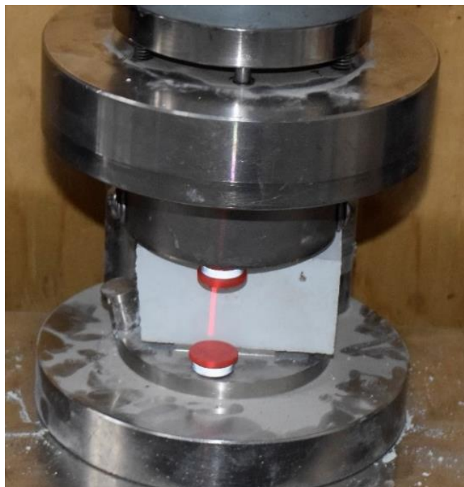
Obr. 7.25: Přípravek na zkoušku v tlaku s osazeným trámečkem
