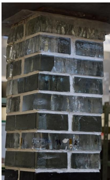
Obr. 8.52: Zkušební těleso č.1 (vrstvy č. 1 - 18) po zkoušce
