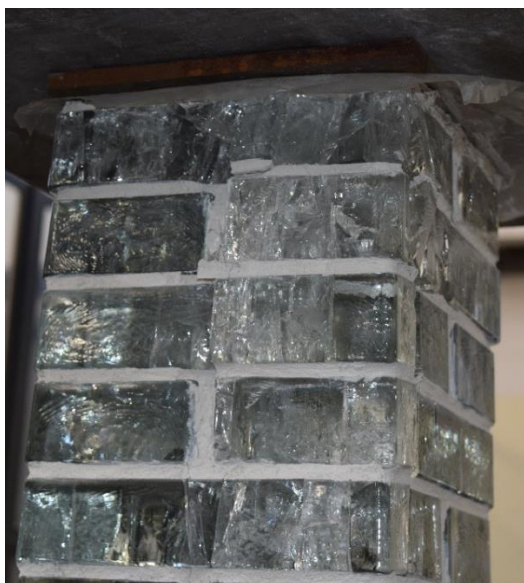
Obr. 8.52: Zkušební těleso č.1 (vrstvy č. 1 - 18) po zkoušce
