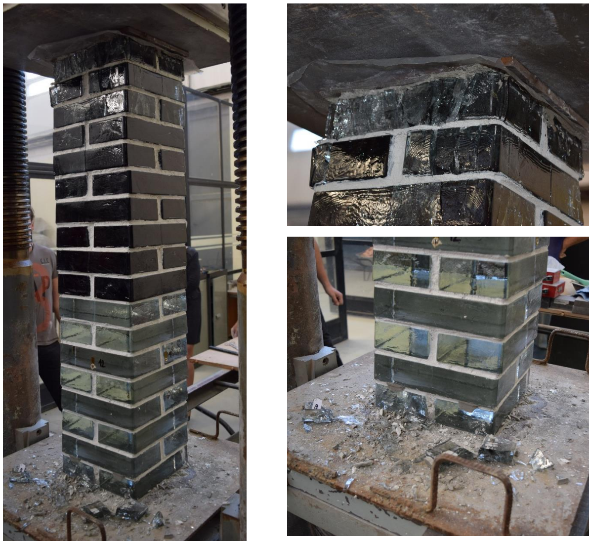
Obr. 8.53: Zkušební těleso č. 2 (vrstvy č. 33 - 50) po zkoušce
