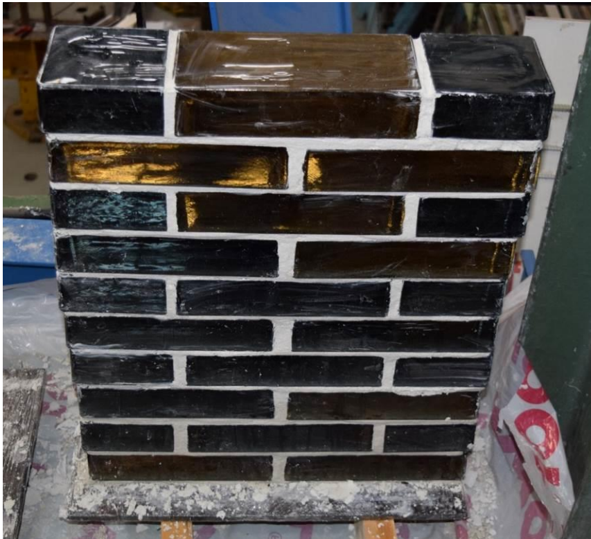
Obr. 8.2: Zkušební těleso C9-01 a C9-02 pro zkoušku v tlaku
