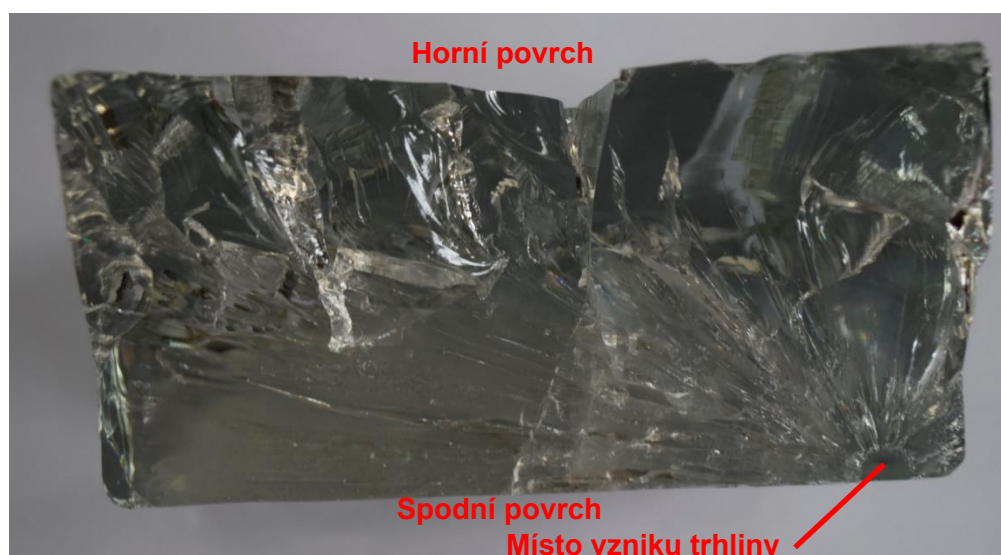
Obr. 7.33: Průřez tělesa porušeného u rohu
