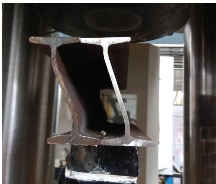
Obr. 8.6: Zdeformované ocelové nosníky po experimentu (těleso C9-01)
