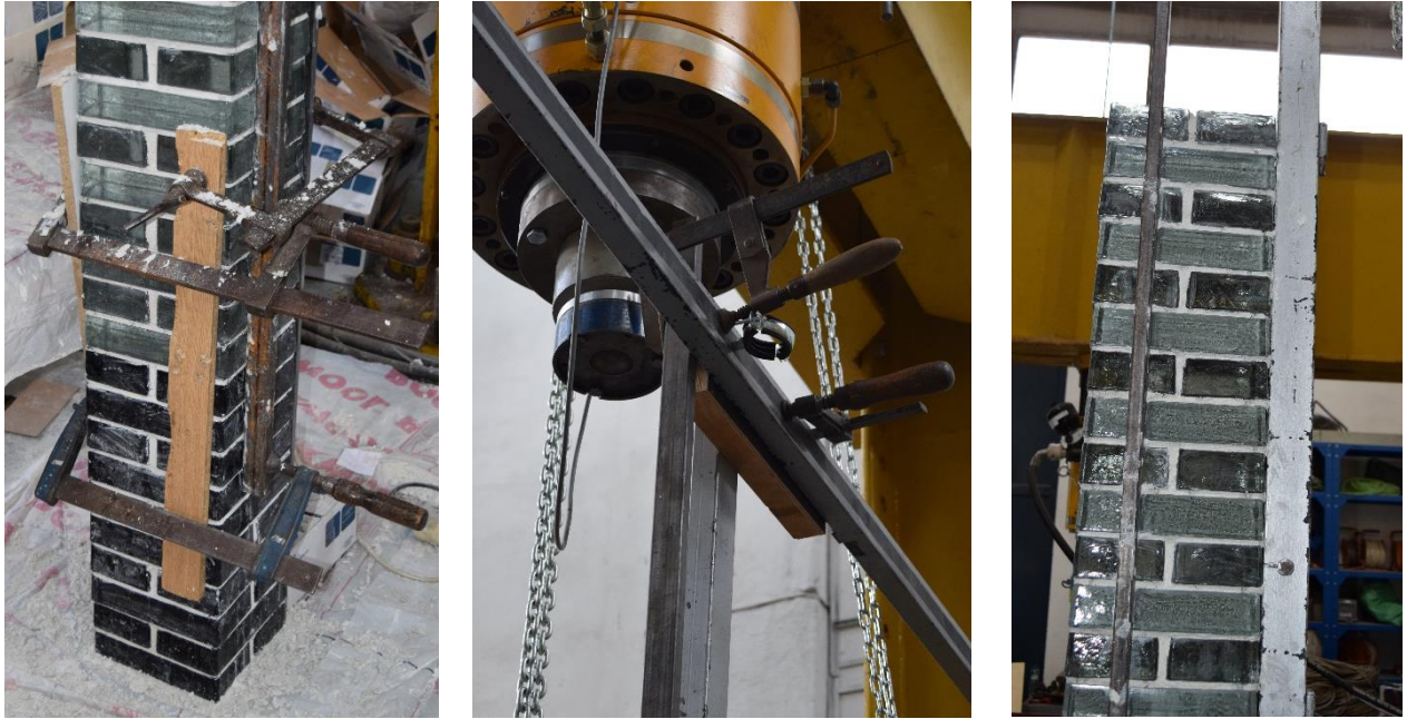
Obr. 8.22: Ocelové profily pro zajištění svislosti pilíře
