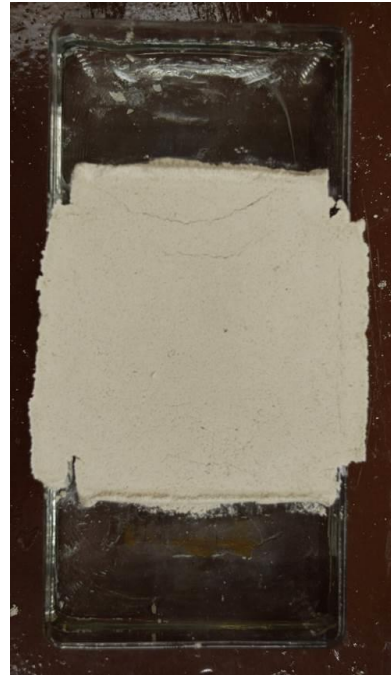
Obr. 7.18: Typické adhezí porušení
