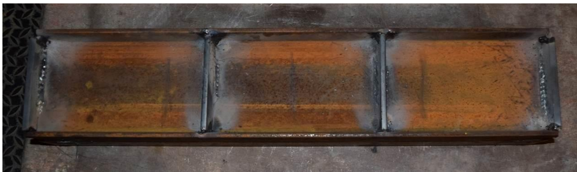
Obr. 8.7: Roznášecí nosníky s přivařenými výztuhami
