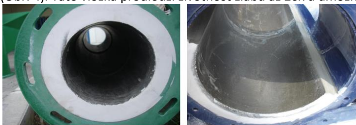
Obr. 4: Čedičová vložka (RATAJ a.s., 2018)
