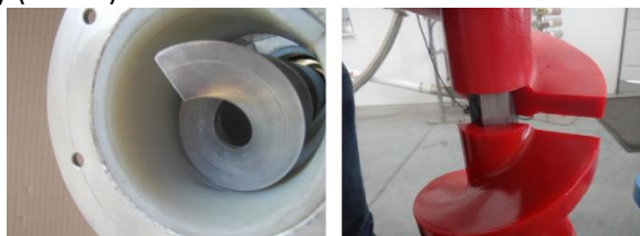
Obr. 5: Plastová vložka/spirála (RATAJ a.s., 2018)
