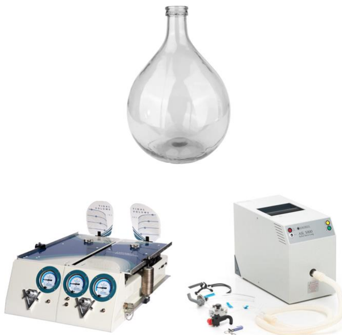
Obr. 2.7: Modely plicní mechaniky. Shora zleva: rigidní model poddajnosti, model s měchy nastavitelnou poddajností a aktivní model plicní mechaniky. Převzato z [21]
