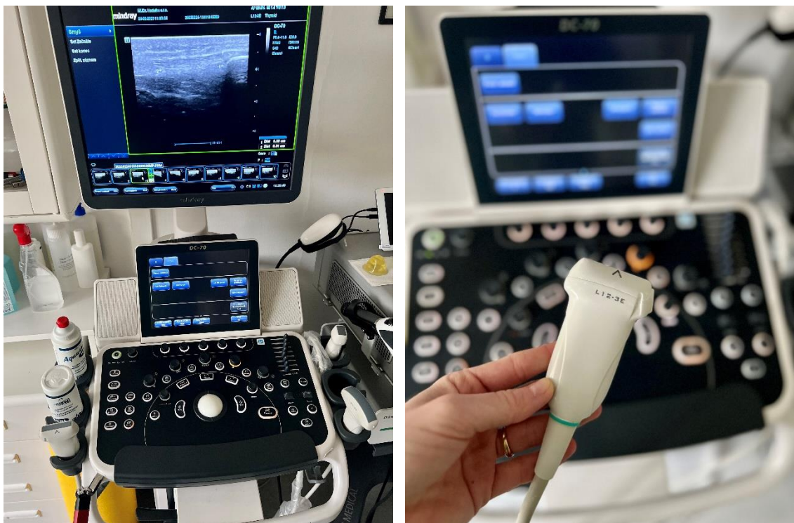
Obrázek 6 - Ultrasonografický přístroj Mindray DC – 70 lineární sonda typu L12-3E [vlastní zdroj].
