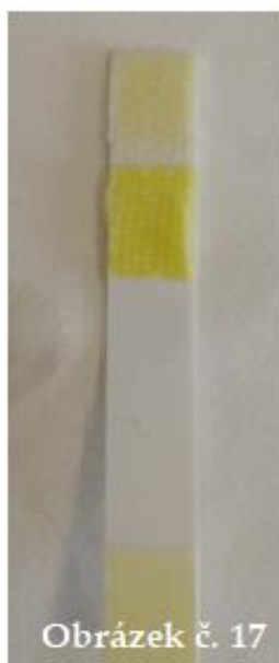
Obrázek 17 Prostředek Detehit po 60s expozici roztoku diethylkyanmethylfosfonátu o koncentraci 60 \text{ mg/l}^{-1} , 0,34 \text{ mol/l}^{-1} [vlastní zdroj]
