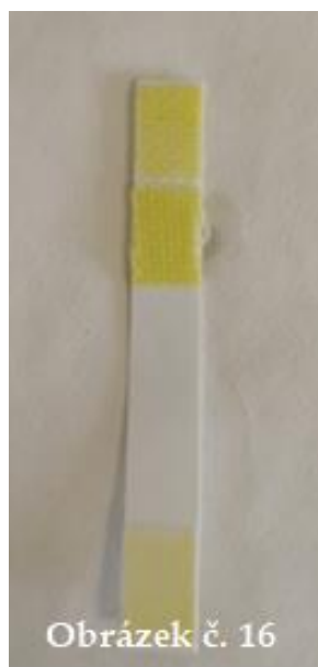
Obrázek 16 Prostředek Detehit po 60s expozici roztoku diethylkyanmethylfosfonátu o koncentraci 15 \text{ mg/l}^{-1} , 0,084 \text{ mol/l}^{-1} [vlastní zdroj]
