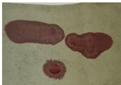
Obrázek 27 Zbarvení simulantů BCHL H (vlevo), G (dole uprostřed) a V (vpravo) na detekčním papírku M9 [vlastní zdroj]
