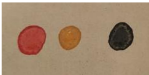
Obrázek 24 Komparace zbarvení jednotlivých simulantů BCHL použitých u detekce pomocí detekčních papírků PP-3 [vlastní zdroj]
