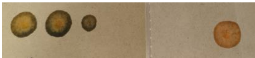
Obrázek 25 Komparace zbarvení simulantu G látky (vlevo) a diethylkyanmethylfosfonátu (vpravo) po 10 minutách [vlastní zdroj]
