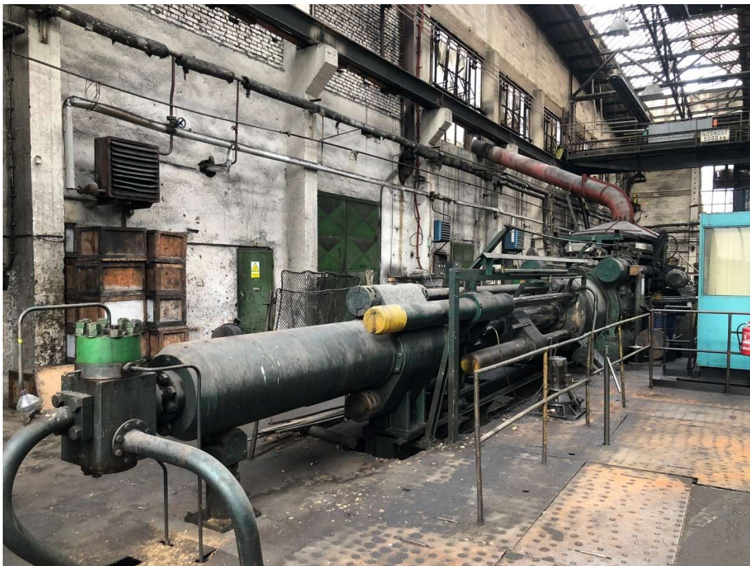
Obr. 179 – Lisovna, interiér – speciální lis na protlačování trubek za tepla, Zdroj: archiv autora
