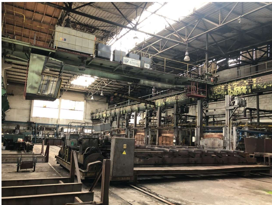
Obr. 154 – Plynová žíhárna, interiér s komorovými žíhacími pecemi, 2022, Zdroj: archiv autora
