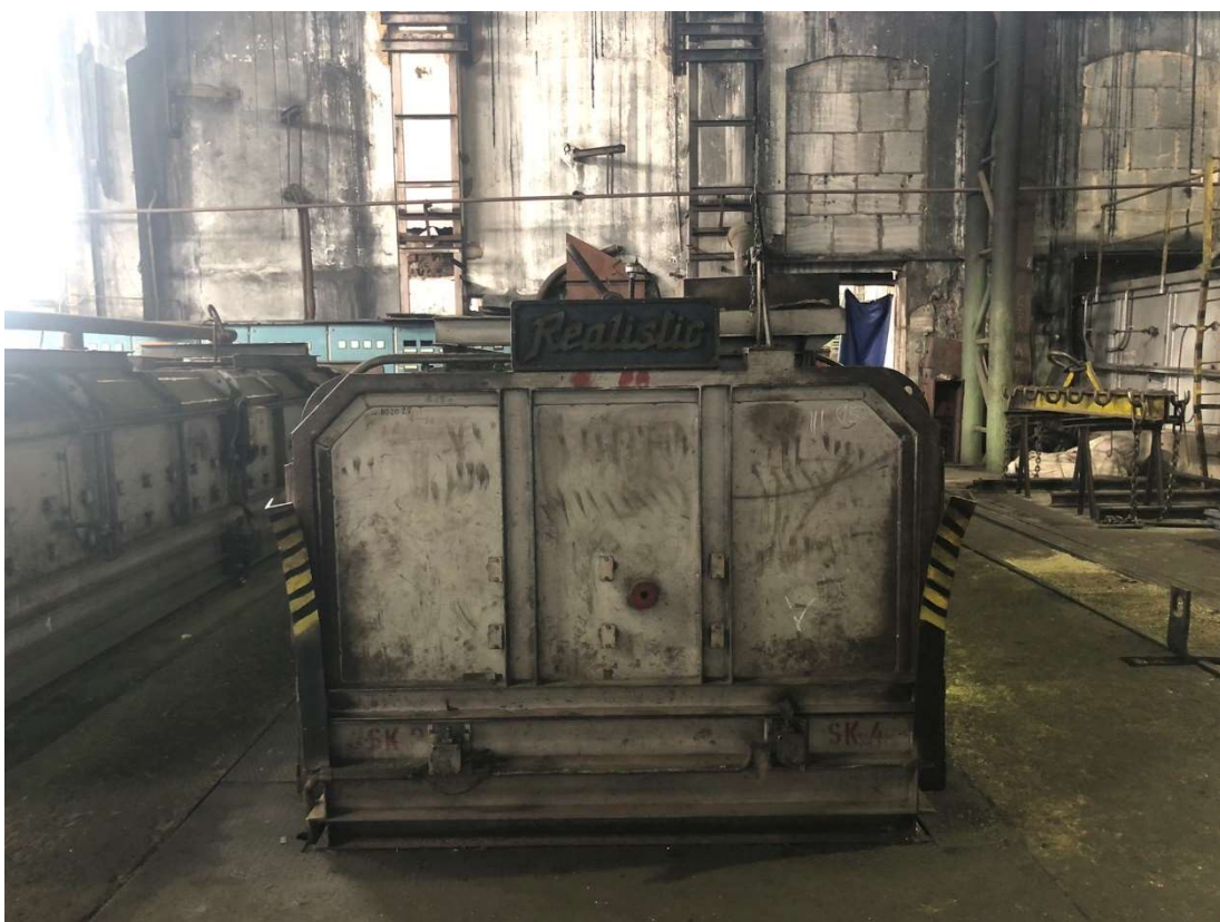
Obr. 106 – Část žíhárny, detail elektrické žíhací pece, 2022. Zdroj: archiv autora
