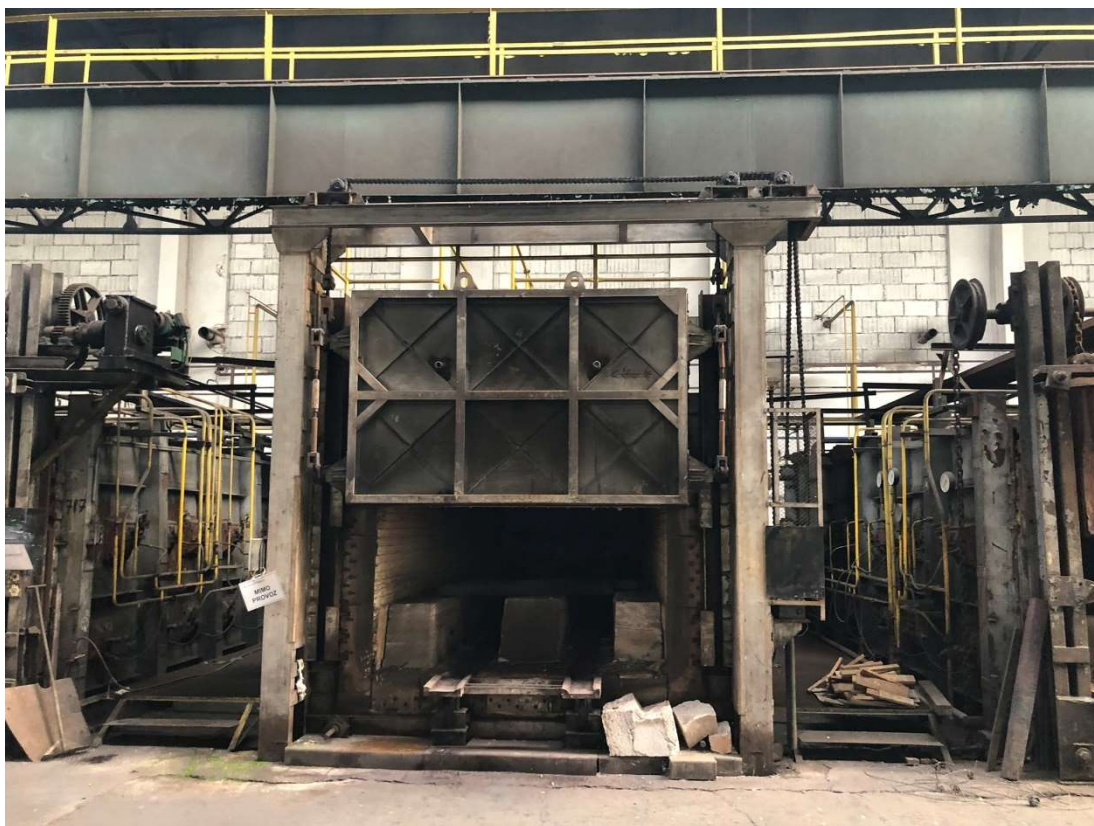
Obr. 156 – Plynová žihárna, detail jiného typu komorové žihací pece, 2022, Zdroj: archiv autora
