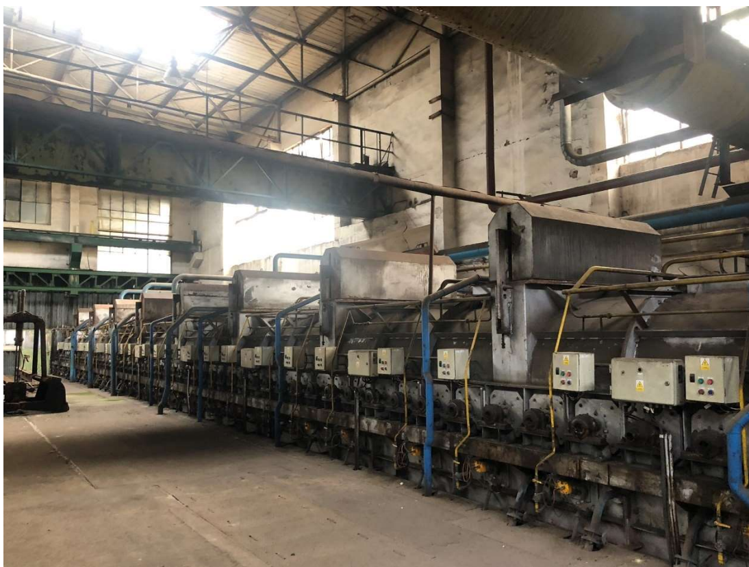
Obr. 157 – Plynová žihárna, průběžná plynová žihací pec, 2022, Zdroj: archiv autora
