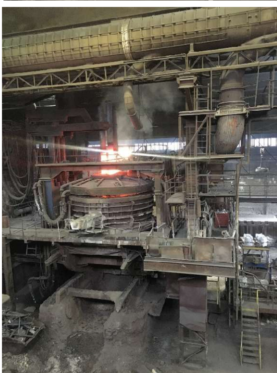
Obr. 214 – Elektroocelárna, fotografie obloukové pece s odpichem oceli do pánve, 2018, Zdroj: archiv autora
