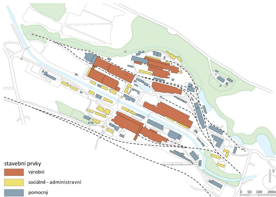
Obr. 337 – Schéma areálu železářny v Hrádku se zobrazením typologického rozdělení objektů
