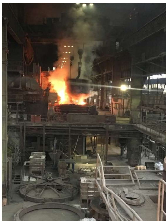
Obr. 214 – Elektroocelárna, fotografie obloukové pece s odpichem oceli do pánve, 2018, Zdroj: archiv autora
