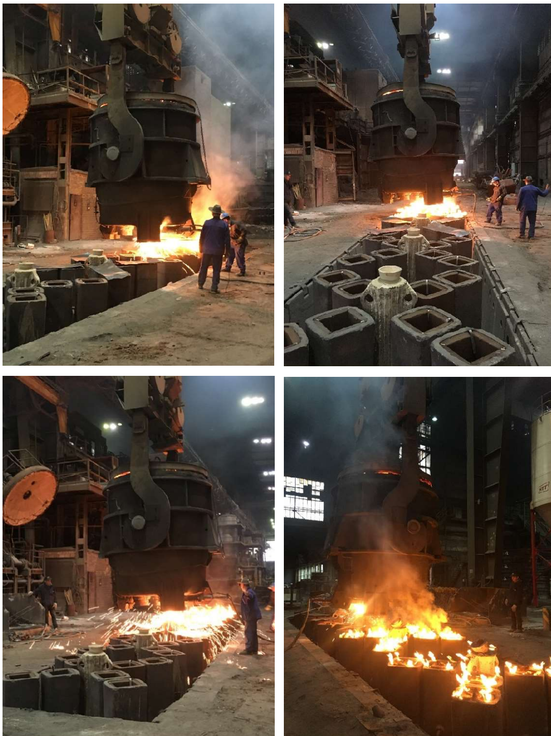
Obr. 215 – Elektroocelárna, fotografie odlévání ingotů, 2018, Zdroj: archiv autora
