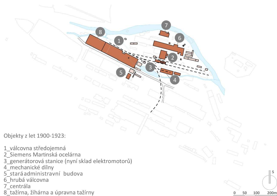
Obr. 41 – Schéma historické etapy výstavby areálu železárny Hrádek z let 1900-1923. Mapový podklad: Situace Akciové železárny a ocelárny v Hrádku z roku 1913, dostupná ve Státním oblastním archivu v Plzni – Fondy podnikových a hospodářských subjektů, Hrádek, kart.7.
