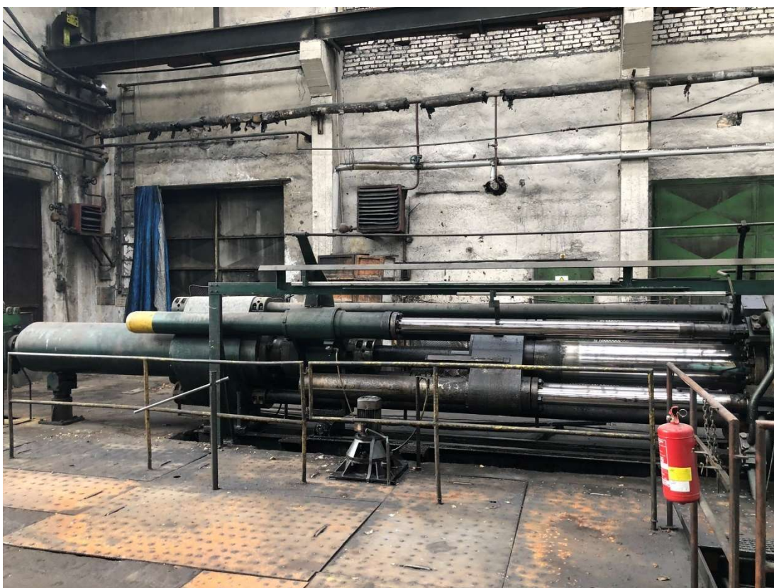
Obr. 180 – Lisovna, interiér – speciální lis na protlačování trubek za tepla, Zdroj: archiv autora
