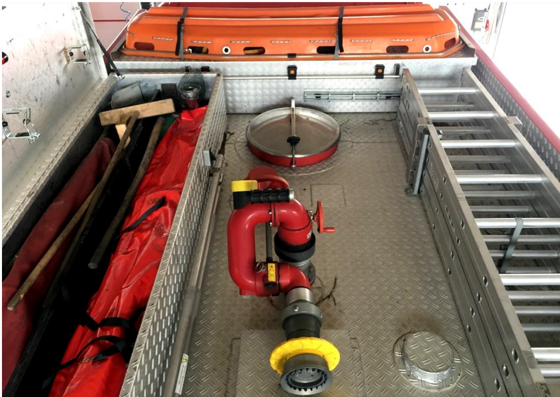
Obrázek 6 - Vozidlo Scania, CAS 20/3000/200 S2R , pohled na střešní vybavení
