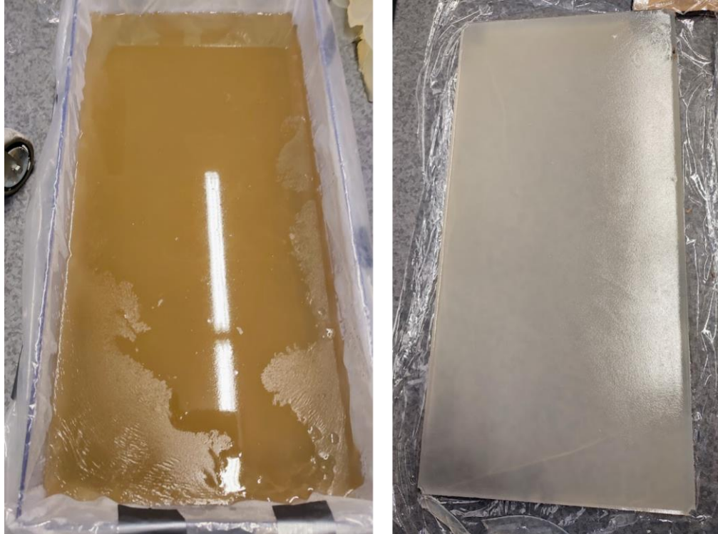
Obr. 4.7.2.: Forma pro odlití fantomu (vlevo), hotový plát fantomu (vpravo)
